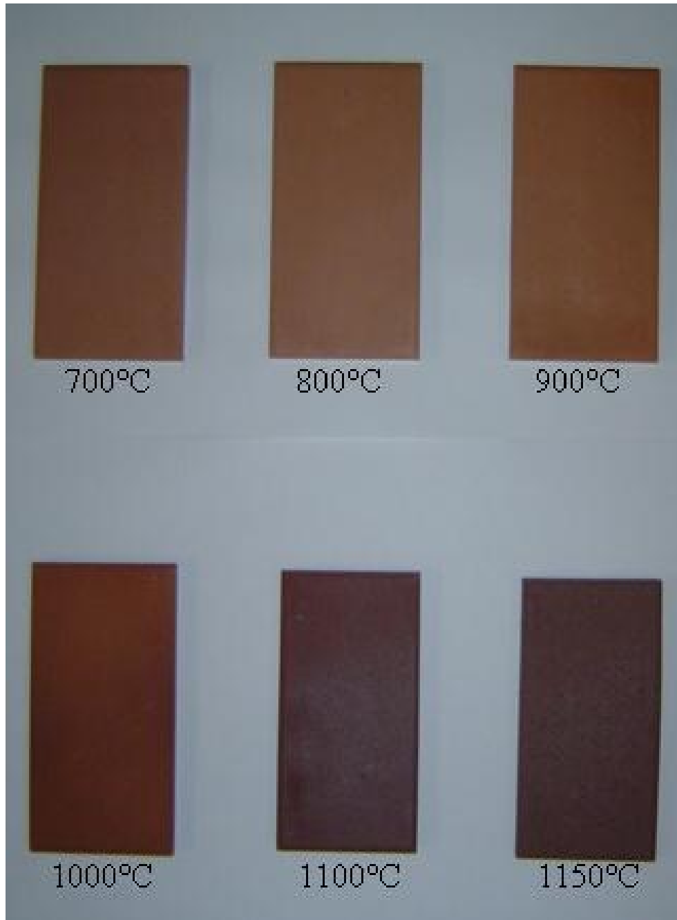
Figura A. 5 - Ilustração dos corpos de prova da amostra D, para diferentes temperaturas.
