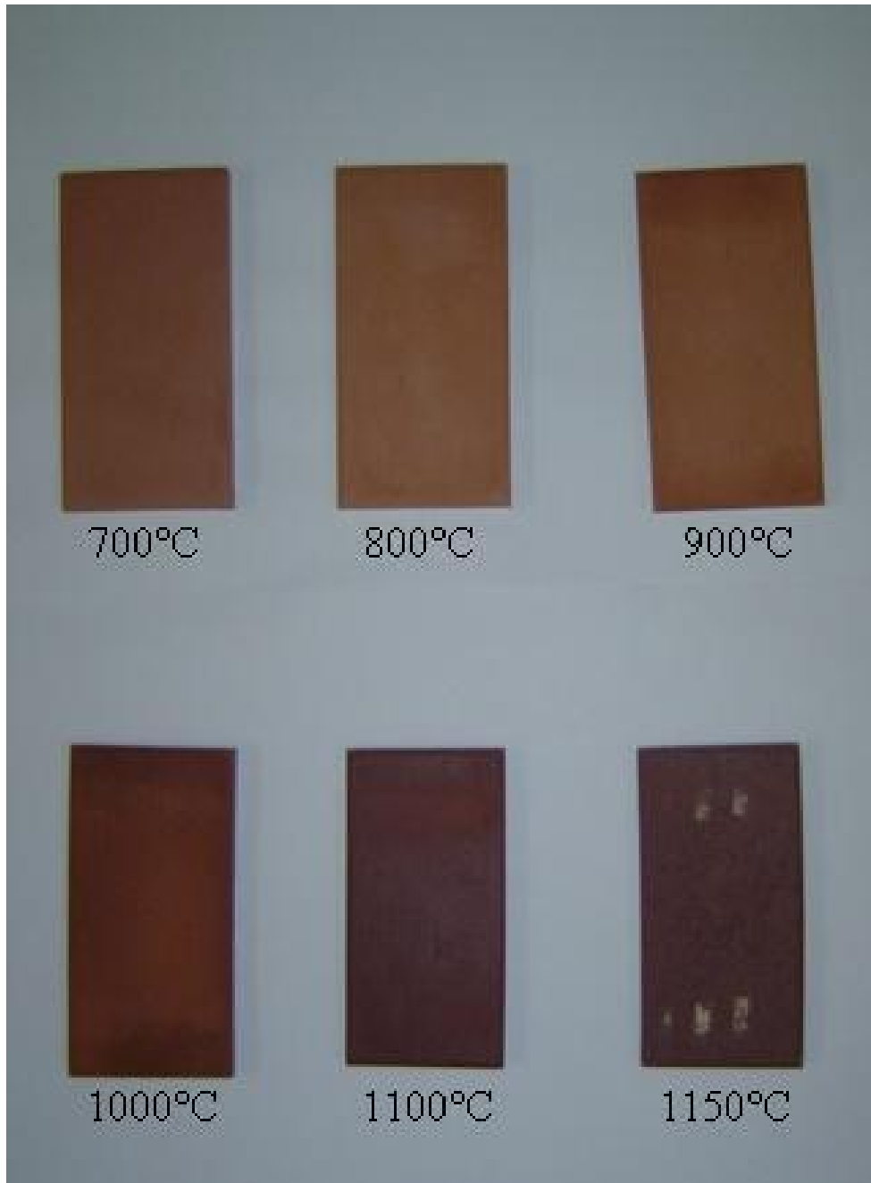
Figura A. 6 - Ilustração dos corpos de prova da amostra E, para diferentes temperaturas.
