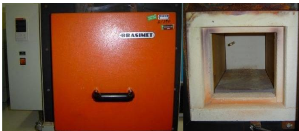
Figura 3.5 – Forno tipo mufla - Brasimet (esq.) – Vista interna do forno (dir.).
