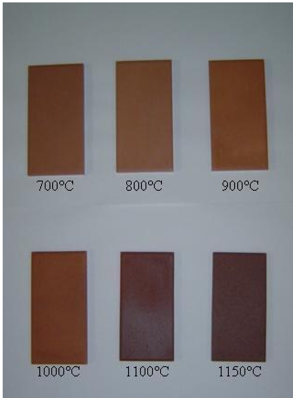
Figura A. 4 - Ilustração dos corpos de prova da amostra C, para diferentes temperaturas.
