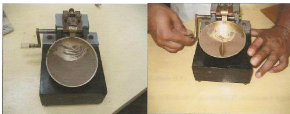
Figura 3.2 – Massa alisada (esq.) – Massa no cinzel de Casagrande com ranhura (dir.).
