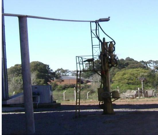
Figura 10: Coleta de amostras utilizando o calador
