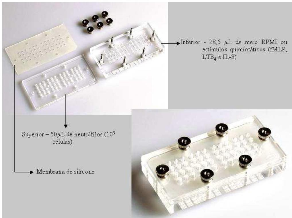
**Figura 5:** Microcâmara de quimiotaxia: os neutrófilos ( $1 \times 10^6$  células/ml) foram colocados na câmara superior e os estímulos quimiotáticos ( $10^{-7}$ M) fMLP, LTB<sub>4</sub> e IL-8 na câmara inferior.
