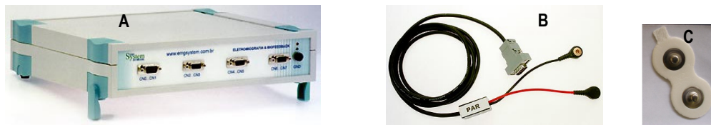
Figura 4 - Eletromiógrafo da EMG System do Brasil (A), interface ativa (B) e eletrodo descartável do tipo double da EMG System do Brasil (C).
