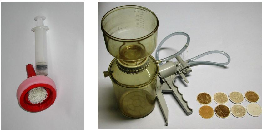
Figura 8. Fotografia do amostrador de Perifíton (Loeb 1981) e material de filtração formado pelo suporte e bomba de sucção junto com os filtros de sílica.
