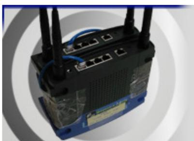
Figura 3: Dois roteadores WRT54G da Linksys ligados por suas portas *Ethernet* formando o nó da rede Meshnet
