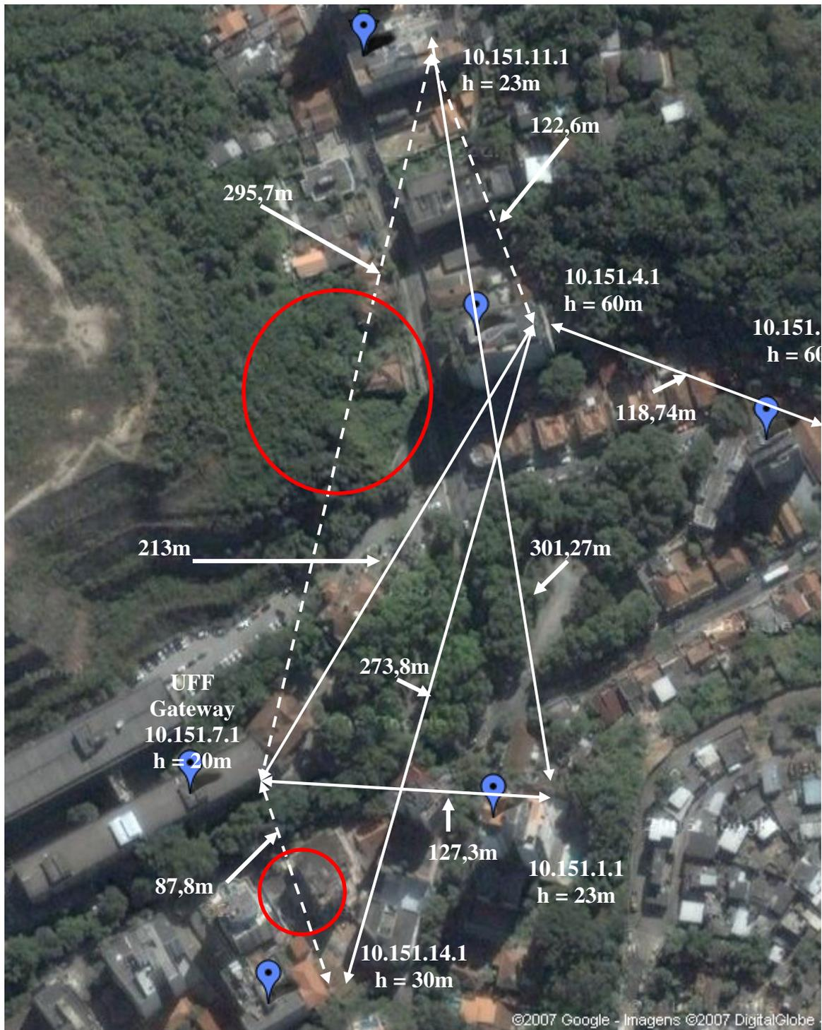
Figura 25: Topologia da rede externa com identificação dos nós, suas alturas e comprimento dos enlaces principais e secundários (GOOGLE MAPS, 2007)
