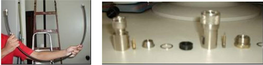
Figura 16: Da esquerda para a direita: cabo RGC 213 e conectores RP-TNC e N-Macho
