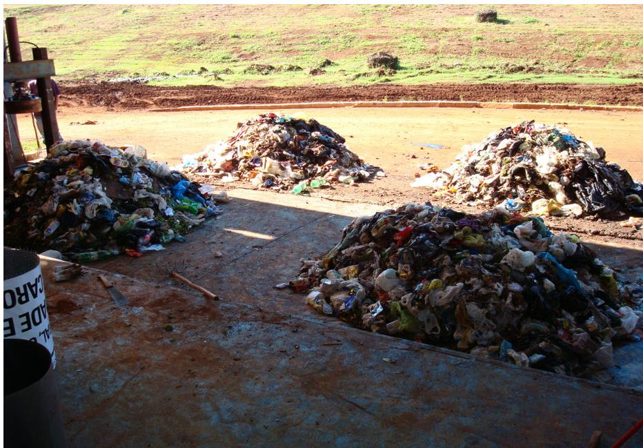
Figura 4.1 Pilhas de resíduo obtidas durante o quarteamento nas dependências do aterro sanitário de Ribeirão Preto
