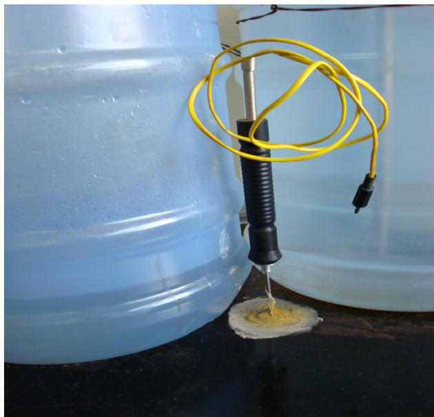
Figura 4.8 Termopar de imersão instalado na tampa dos lisímetros
