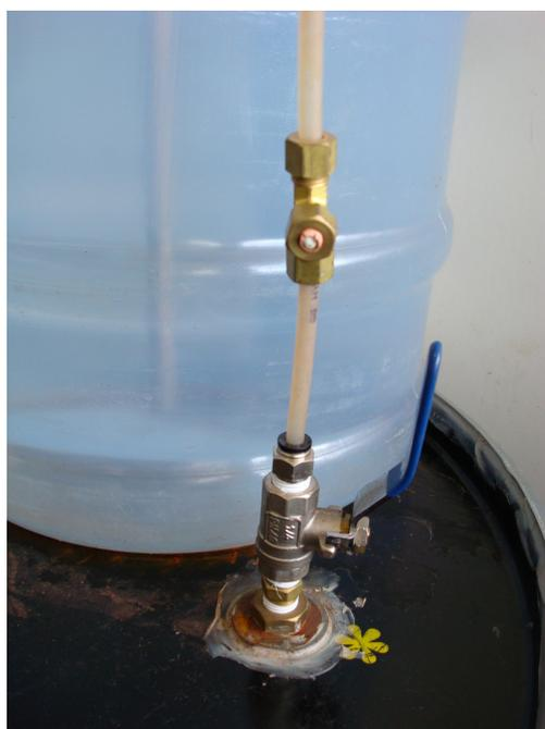
Figura 4.10 Septo adaptado a uma conexão Tê para coleta de biogás e registro de estanqueidade
