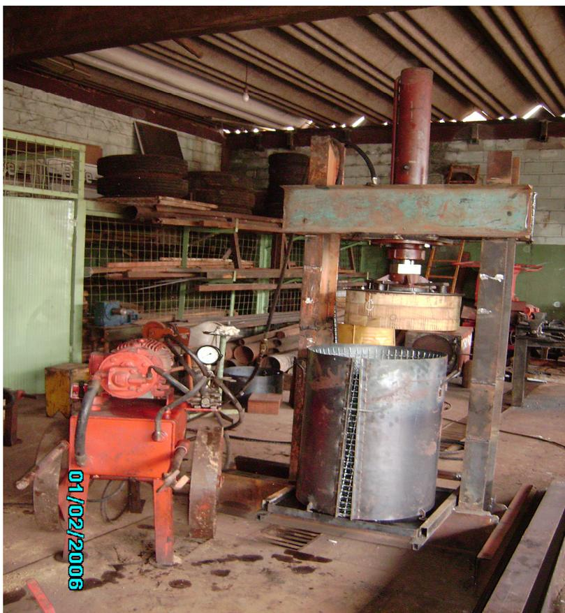
Figura 4.6 Conjunto moto bomba, prensa e camisa de aço em fase de testes
