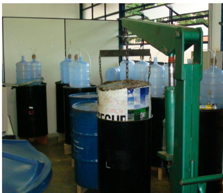
Figura 4.7 Macaco hidráulico modelo girafa em processo de assentamento
