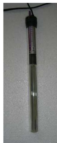
FIGURA 8 – Termostato eletrônico de 200 W ViaAcqua.
