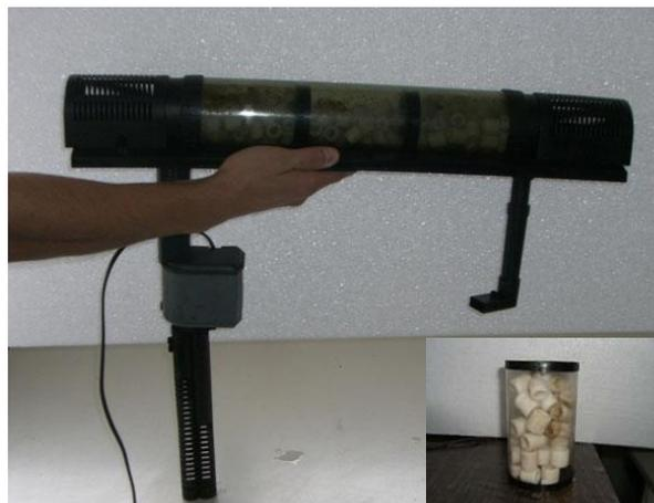
FIGURA 12 - Sistema de filtragem biológica composto por uma bomba de 1500 L/h e anéis de cerâmica utilizada para a filtragem do aquário.
