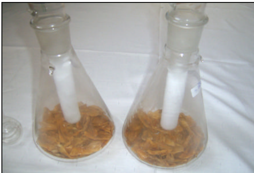
Figura 6 – Sistema fechado de coleta de voláteis por headspace dinâmico.
