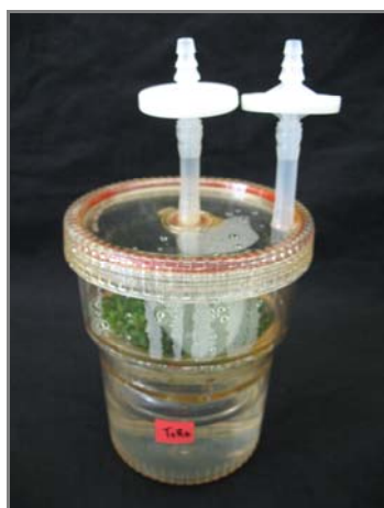
Figura 2 – Modelo do recipiente de imersão temporária automatizada – RITA ® , utilizado nesta experimentação.
