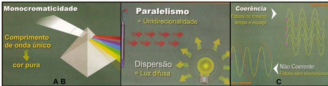
Figura 7 – A) Monocromaticidade; B) Colimação; C) Coerência.
