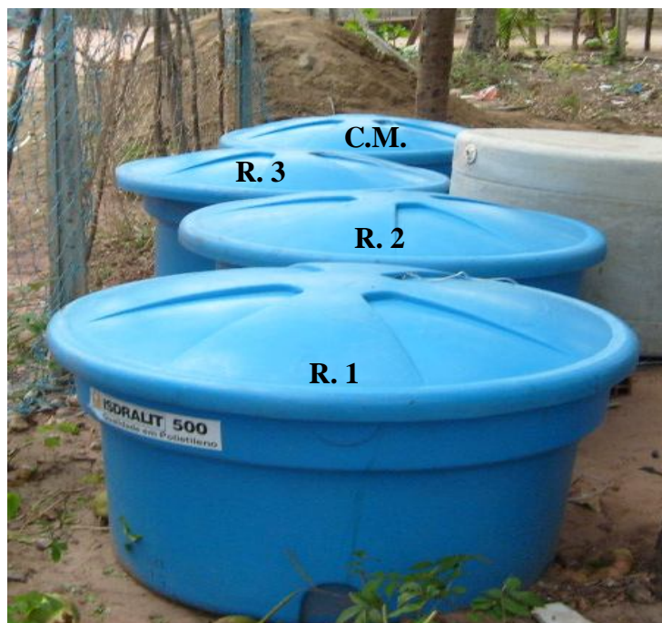
FIGURA 2: Caixas d'água experimentais de 500L (R.1, R.2, R.3) e da cultura Mãe (C.M.) utilizadas no cultivo da microalga.
