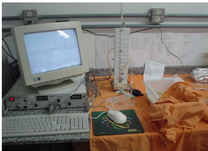
Figura 3 – Ilustração da conexão entre a cânula, transdutor eletromagnético e do sistema de registro de pressão arterial.
