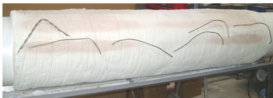
Figura 5.5. Conjunto de resistores recoberto por camadas de pasta cerâmica.
