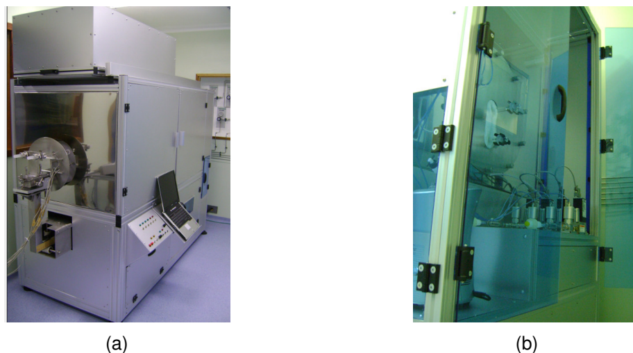
Figura 5.32. Estrutura do forno montada com o conjunto de tampas e portas de alumínio e acrílico instaladas.
