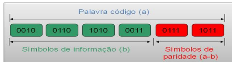
Figura 4.10. Esquema da codificação FEC, utilizando algoritmo Reed-Solomon (a,b) .
