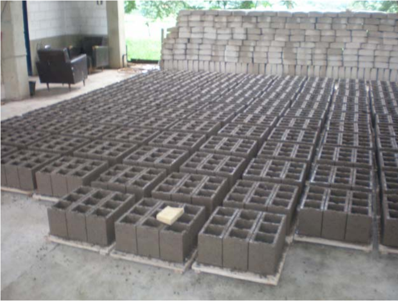
Figura 278. Blocos de concreto fabricados na usina de reciclagem de São José do Rio Preto FONTE: AUTOR (2009)
