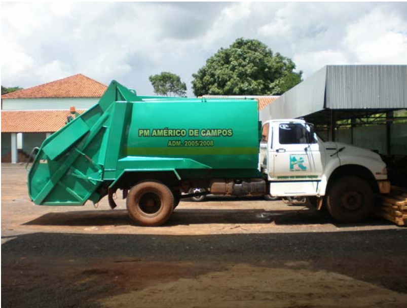
Figura 93. Caminhão compactador de lixo da frota de Américo de Campos
