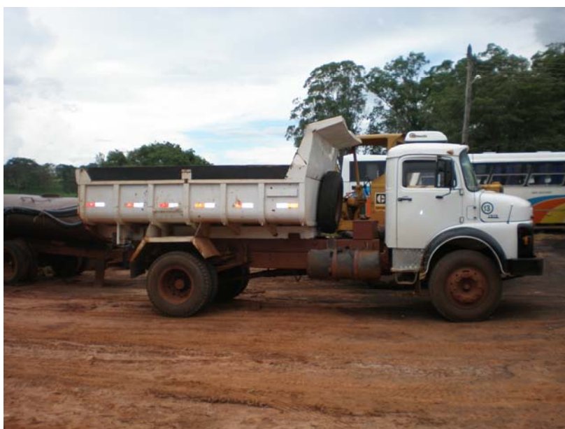
Figura 87. Caminhão basculante utilizado na coleta de entulho em Álvares Florence FOTO: AUTOR (2009)
