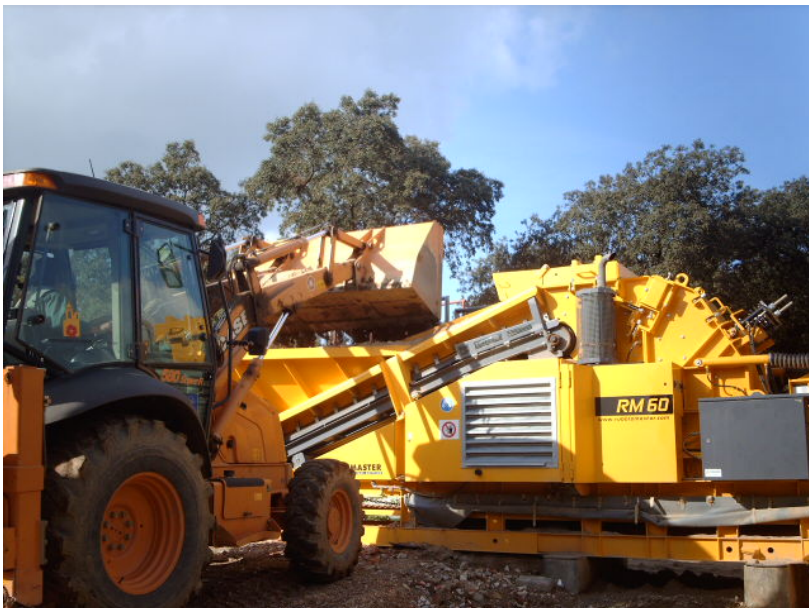
Figura 35. Detalhe do momento da trituração dos resíduos pelo britador FOTO: AUTOR (2007)
