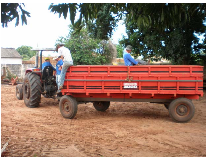
Figura 224. Trator com carreta basculante usado na coleta de entulho de Parisi
