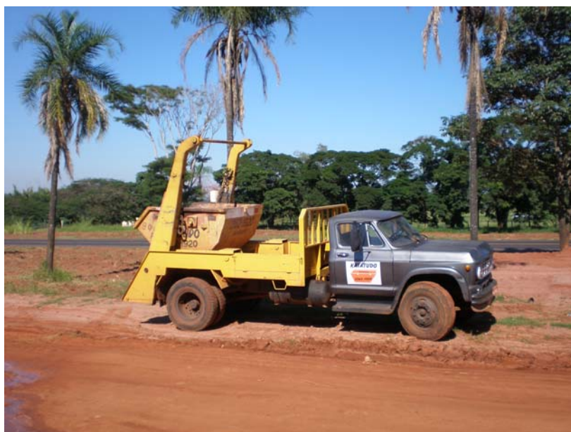
Figura 190. Caminhão poliguindaste de empresa privada de Nova Granada
