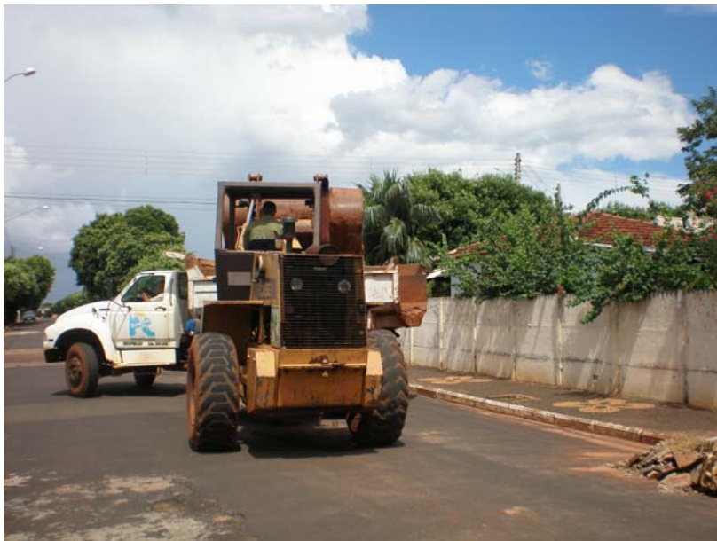
Figura 96. Caminhão basculante recebendo os RCD em Américo de Campos FOTO: AUTOR (2009)
