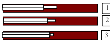
Figura 19: Alinhamento das CI no OS para leituras no raio central. 1- CI tipo farmer, 2- CI RK083 e 3- CI micro Exradin A16.
