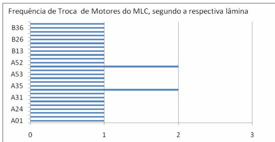
Figura 33: Frequência de troca de motores do MLC com relação às lâminas dos bancos A e B.
