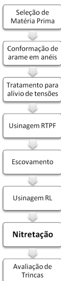
Figura 4.2: Seqüência de processamento dos anéis de pistão.
