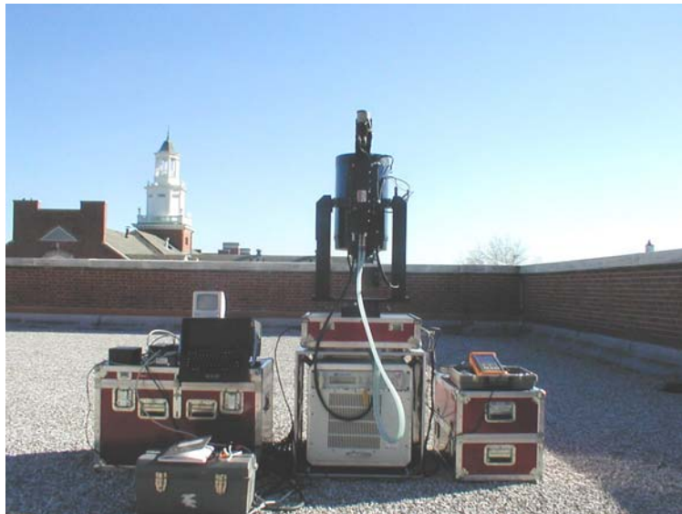
Figura 3.12a: Sistema LIDAR de JHU. (Fonte: http://www.jhu.edu/~dogee/mbp/research/lidar/main.htm ).
