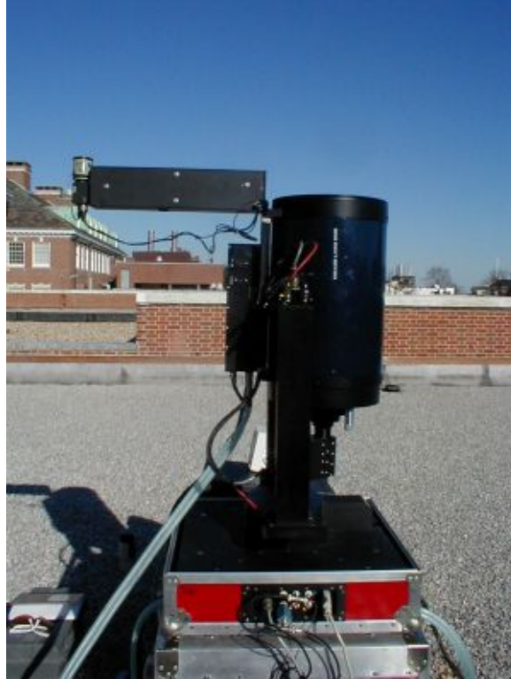
Figura 3.12b: O transmissor (laser e periscópio) e os componentes do receptor (telescópio e detector) (Fonte: http://www.jhu.edu/~dogee/mbp/research/lidar/main.htm ).
