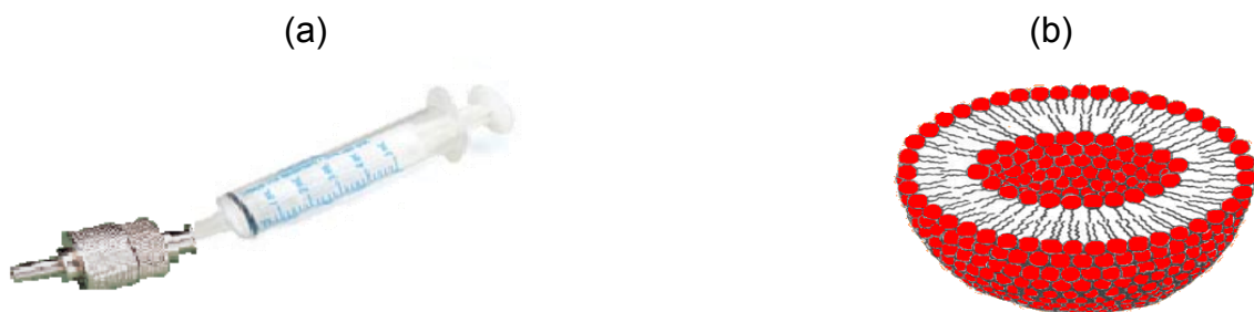
Figura 22. Imagem (a): sistema de extrusão utilizado para a produção de LUVs a partir das MLVs . Imagem (b): estrutura da vesícula grande unilamelar ( LUV ) (adaptado de DE LIMA, 2005).
