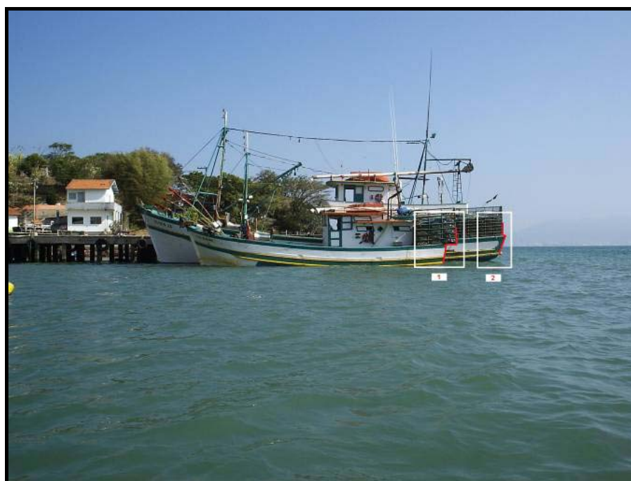
Figura 11: Detalhe das “gaiolas” de transporte de rede em duas embarcações no Píer do Araçá, município de Porto Belo (SC). Em vermelho perfil das “gaiolas”: 1 – modificada para aumentar o poder de pesca de embarcações de menor porte; e 2 – normalmente utilizada por embarcações de grande poder de pesca.
