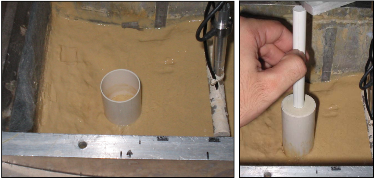
Figura 3.49 – Mini-amostrador para extração de solo em centrífuga.
