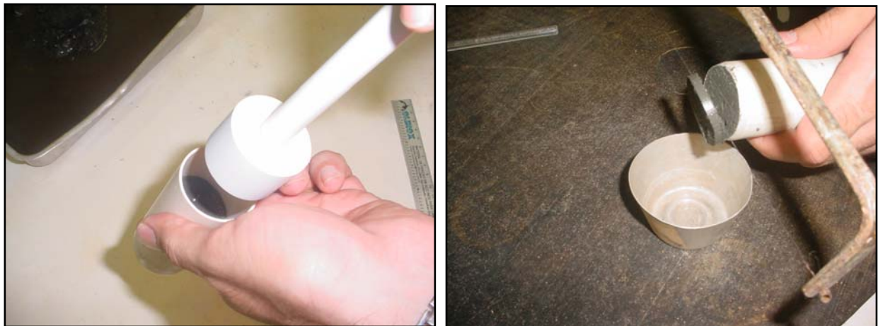
Figura 3.50 – Extrusão e fatiamento de amostra de solo natural adensado em centrífuga.
