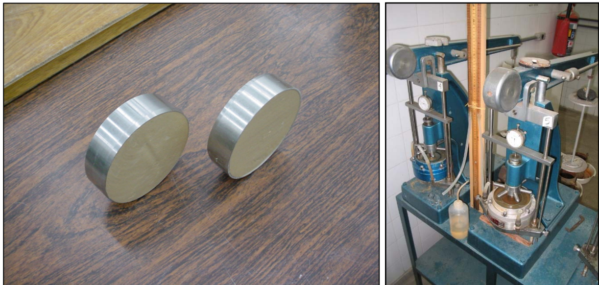
Figura 5.3 – Amostras retiradas e montagem do ensaio de adensamento.
