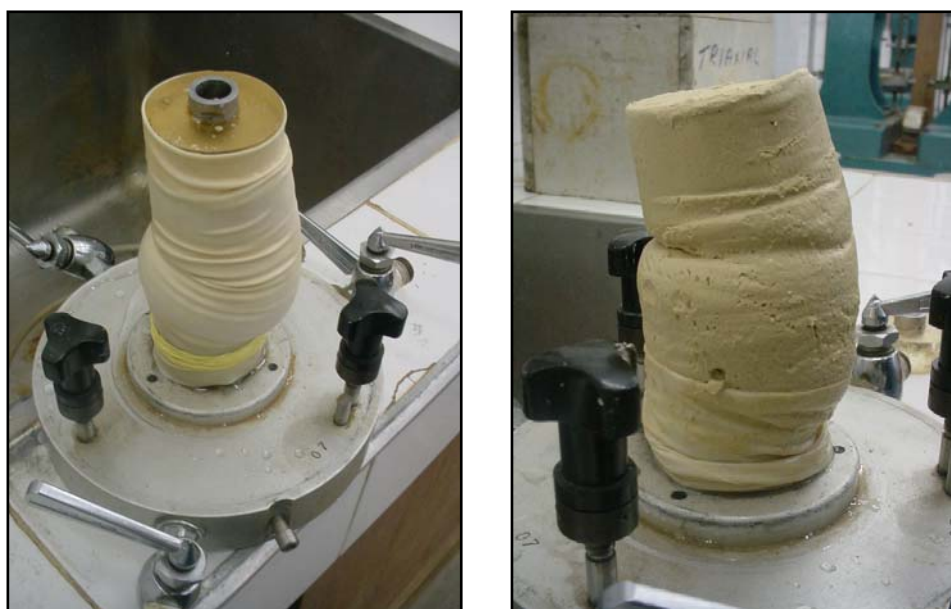
Figura 5.7 – Aspecto de espécime levado à ruptura em ensaio triaxial UU.
