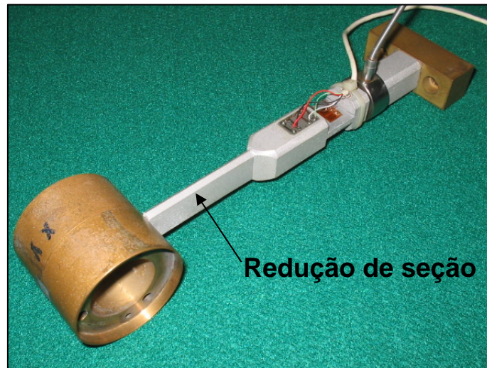
Figura 4.11 – Redução da seção da haste para minimizar interferência com o solo.
