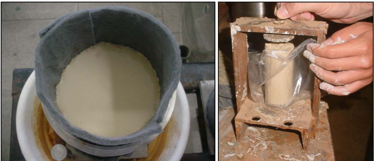
(a) Colocação da lama no cilindro
