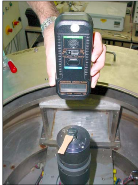
Figura 3.16 – Tacômetro ótico digital utilizado na calibração da velocidade angular.
