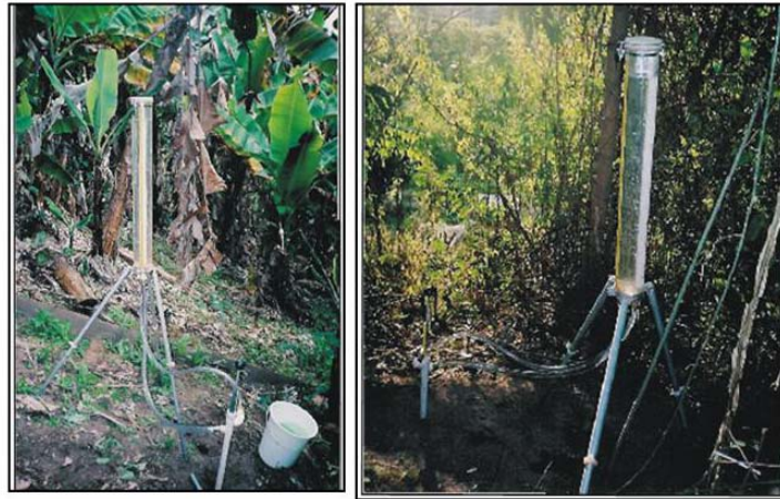
Figura 2.8. Ensaio do Permeâmetro de Guelph realizado em campo; Bom Jardim – RJ.
