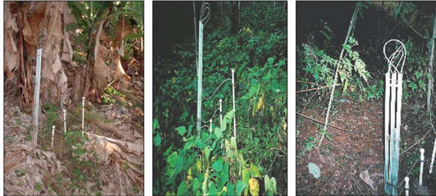
Figura 2.25. Conjunto de tensiômetros instalados em diferentes profundidades nas parcelas sob cultivo de banana, cultivo rotacionado e em pousio.
