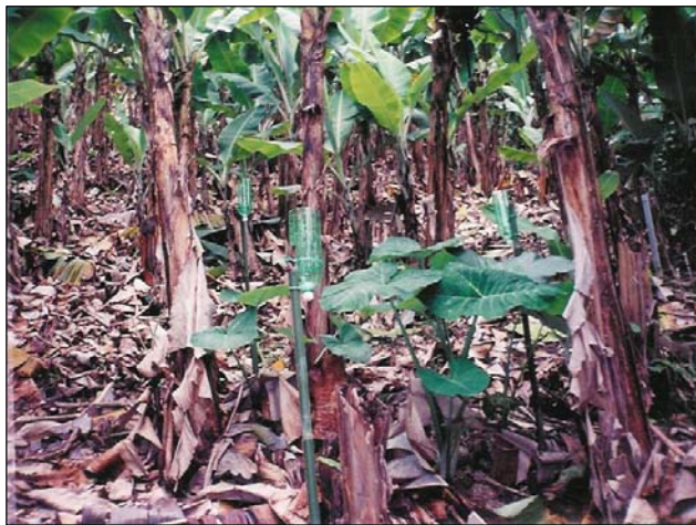
Figura 2.27. Conjunto de pluviômetros PET instalados na parcela sob cultivo de banana.
