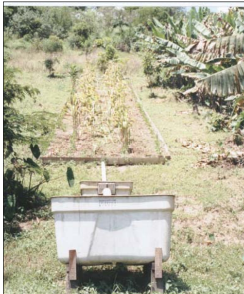
Figura 2.14. Parcela de perda de solo sob cultivo de milho ( Zea mays L. ).
