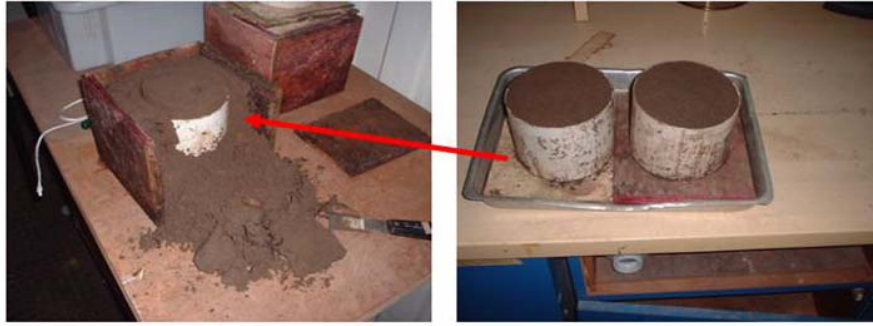
Figura 2.27. Detalhe das amostras inseridas nos cilindros de 15 cm de diâmetro, extraídas dos blocos indeformados (25 x 25 cm) de solo coletados em campo.
