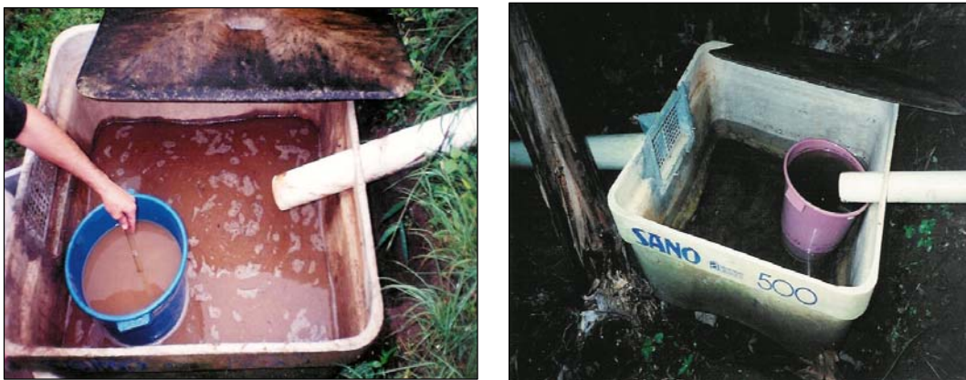
Figura 2.13. Volumes de enxurradas armazenados nos tanques coletores das parcelas de perda de solo em Bom Jardim.
