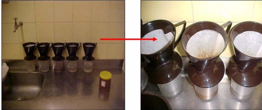
Figura 2.23. Separação do solo removido da encosta da água de enxurrada por meio de filtros de papel 80 G, acomodados em suportes de plástico.
