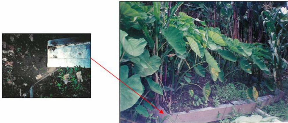
Figura 2.10. Vista do coletor montado nas parcelas de perdas de solo em Bom Jardim; detalhe da borda do coletor.
