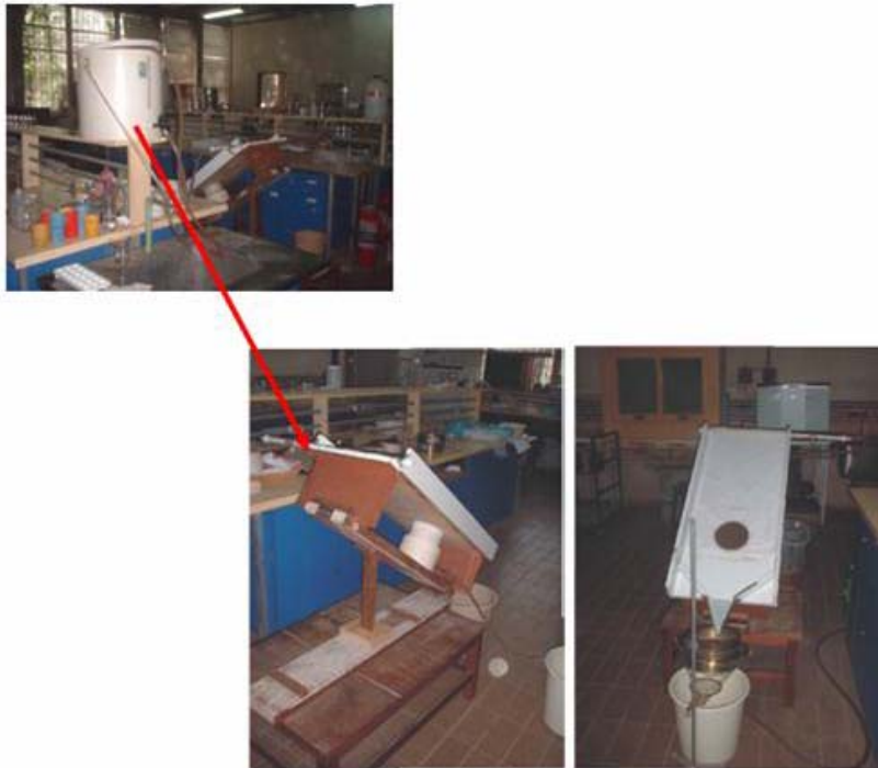
Figura 2.28. Esquema do equipamento modelo “Inderbitzen” para investigação da erodibilidade do solo; em detalhe, o recipiente onde é armazenada a água utilizada no ensaio, a inclinação do equipamento e a disposição da amostra na rampa (Vilela, 2003).
