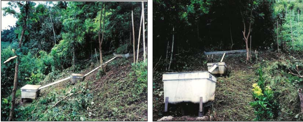
Figura 2.11. Sistema de tanques coletores (caixas d'água de amianto de 500 e 1000 litros) das parcelas de perdas de solo em Bom Jardim.
