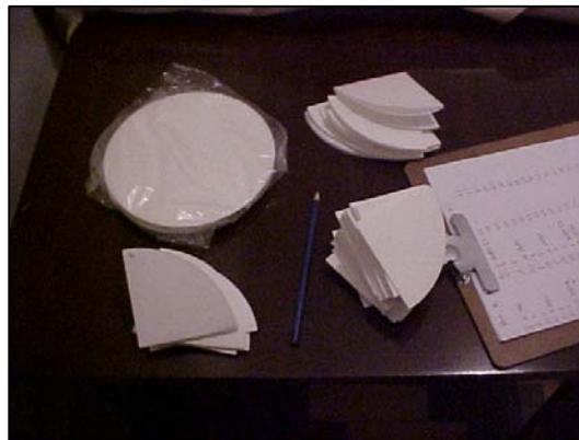
Figura 2.22. Disco de papel filtro NR 589 de 18,5 cm de diâmetro.
