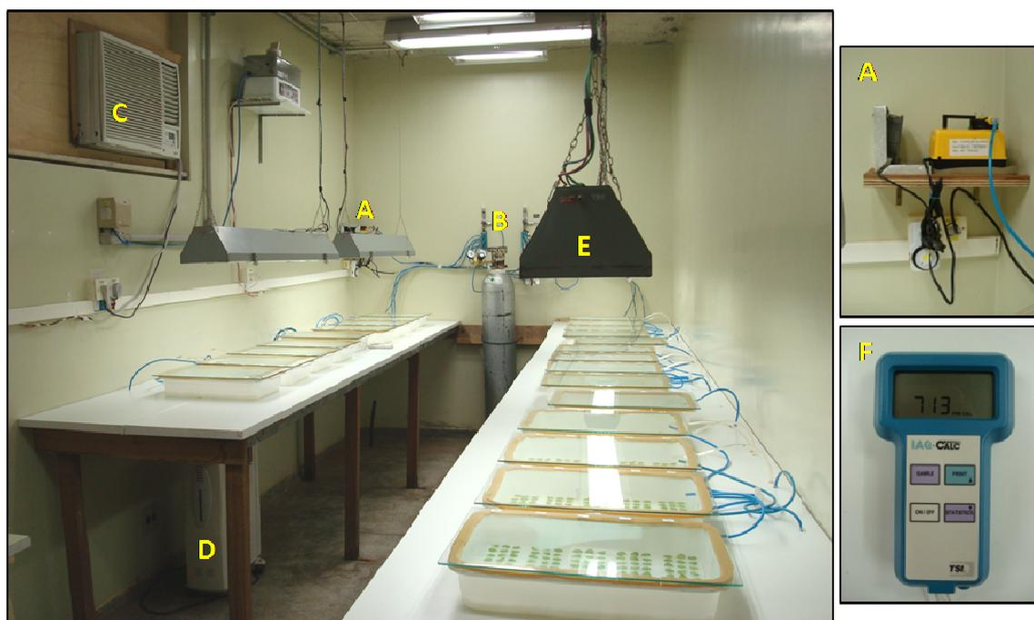
**Figura 1.** Vista geral da sala climatizada. (A) Compressor de ar; (B) Cilindro para injeção de CO<sub>2</sub> puro; (C) Ar condicionado; (D) Aquecedor; (E) Lâmpadas; (F) IRGA.
