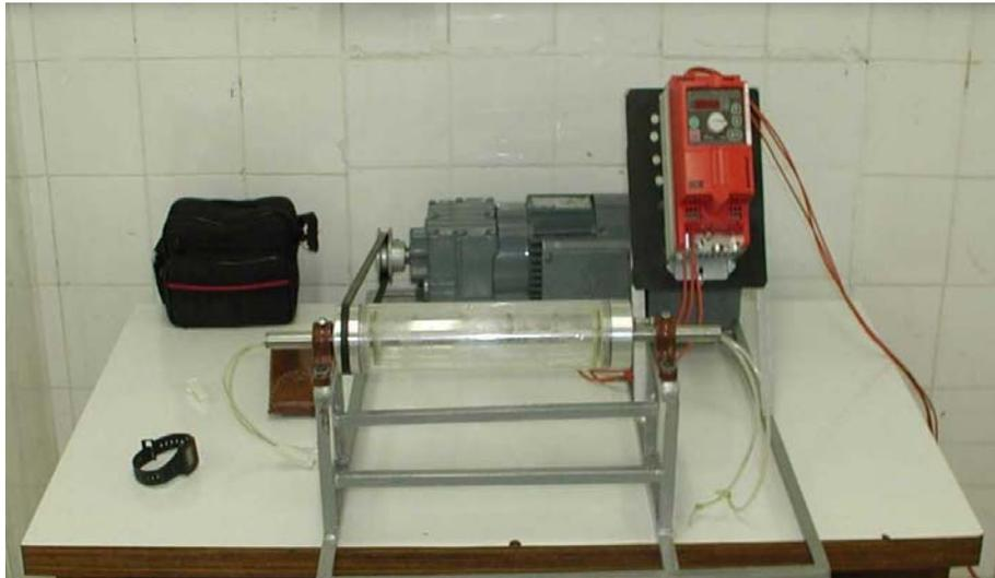
Figura 3.5: Floculador Couette, motor e regulador de giros.
