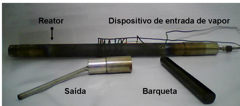
Figura 30. Reator de aço inox utilizado na ativação.
