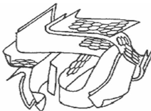
Figura 51. Estrutura tridimensional para carvões proposta por Stoeckli . [74]
