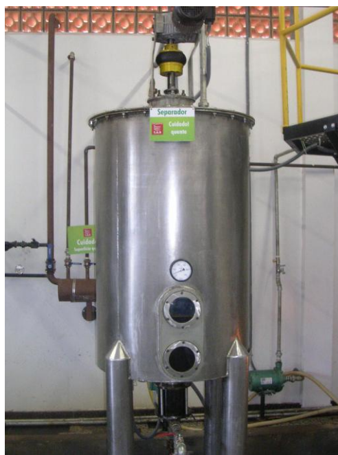
Figura 3: Separador e neutralizador químico Fonte: Arquivo pessoal (2008).
