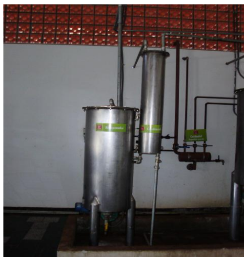
Figura 7: Condensador de metanol e de água Fonte: Arquivo Pessoal (2008).
