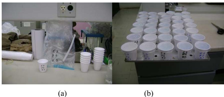
Figura 28: (a) Saco plástico onde o fio coletor era armazenado e lavado (b) potes com o líquido após a lavagem e utilizado na leitura no espectrofotômetro.
