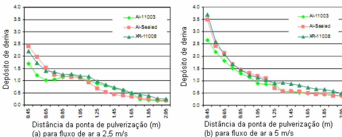
Figura 10: Depósito horizontal de gotas em  $\mu\text{L}/\text{cm}^2$  entre 0,4 e 2,1 m da ponta de pulverização no piso do túnel de vento para duas velocidades e as três pontas de pulverização (GULER, H. ET AL., 2006).
