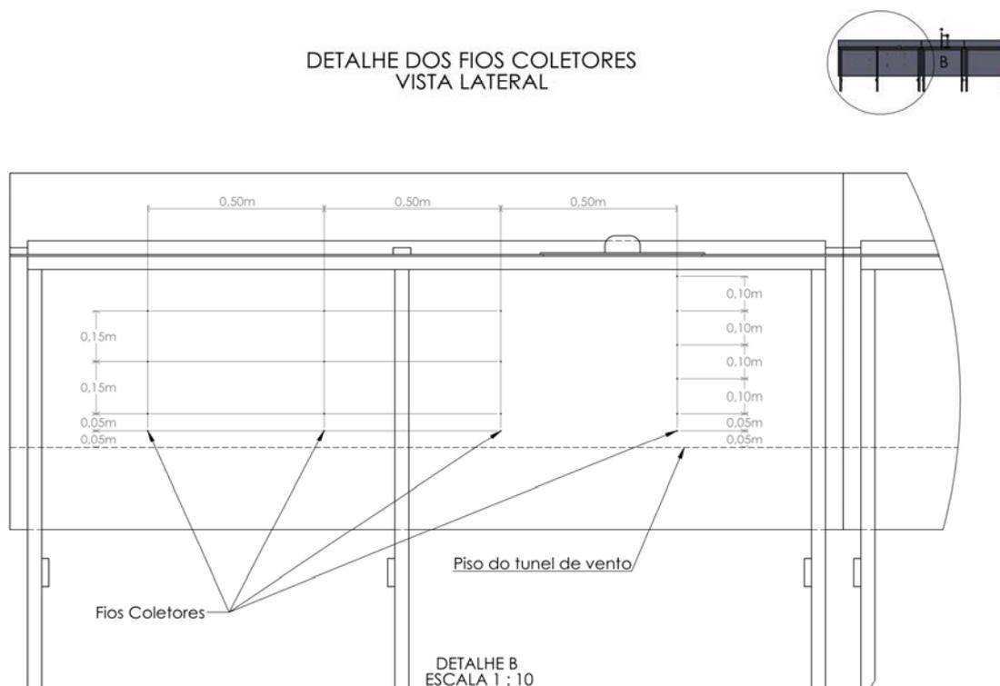
Figura 18. Desenho esquemático do posicionamento dos fios coletores no túnel de vento.
