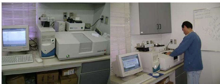
Figura 29: Espectrofotômetro UV-visível utilizado nas medidas de absorbância.
