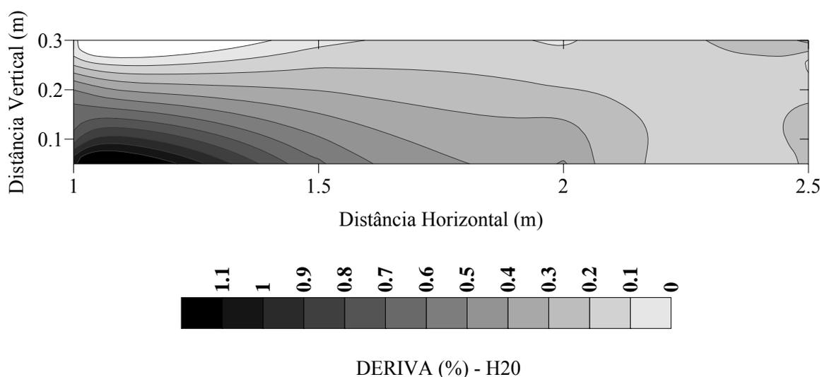
Figura 38: Distribuição espacial do depósito de deriva (%) proporcionada pela calda padrão (água) no interior do túnel de vento.
