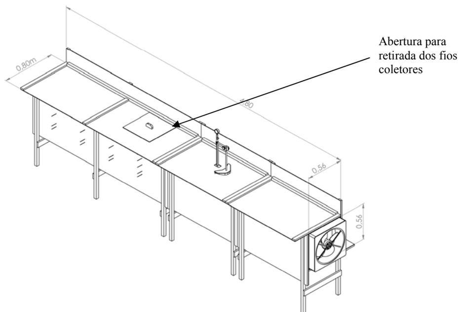
Figura 22: Desenho com as principais dimensões do túnel de vento (m) e abertura para retirada dos fios coletores.
