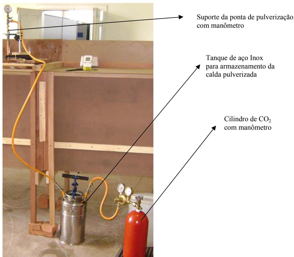
Figura 15- Sistema de pulverização utilizado durante os ensaios.
