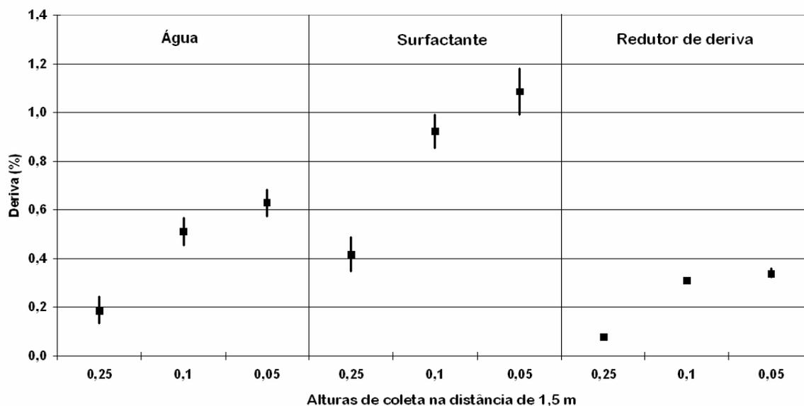
Figura 32: Percentual de depósito de corante com os três tipos de calda a 1,5 m da ponta de pulverização XR8003. Os pontos indicam as médias de cada análise e as barras verticais representam os valores máximos e mínimos de acordo com o IC 95%.
