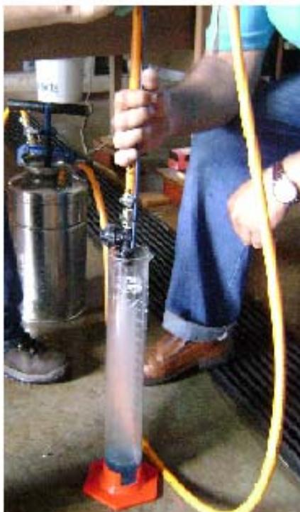
Figura 14- Medida de vazão realizada no laboratório.
