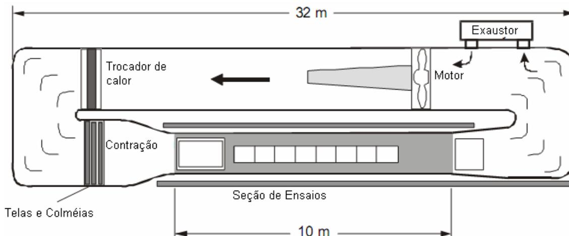
Figura 7: Túnel de vento construído por Herbst (2001).
