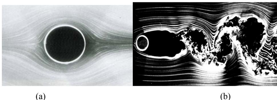
Figura 1: (a) Escoamento Laminar sobre um cilindro  $Re \approx 1.10^1$ . (b) escoamento turbulento sobre um cilindro  $Re \approx 1.10^5$  (<http://www.efluids.com/efluids/pages/gallery.htm>), (SCHLICHTING, H., 1979).
