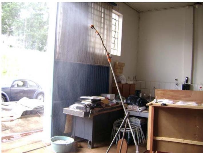
Figura 17: Ponta de pulverização utilizada para umidificar o ar do laboratório.
