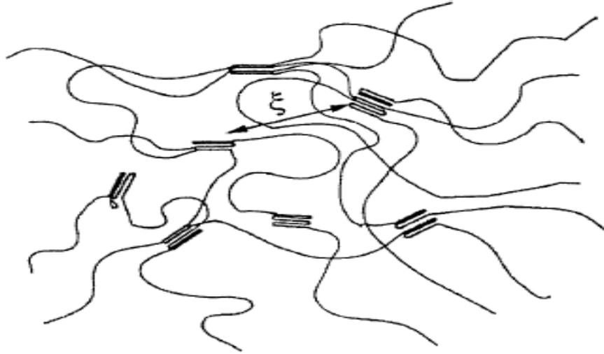
**FIGURA 9** – A estrutura tri-dimensional reticulada do hidrogel obtida por ciclos térmicos [28], representação dos cristalitos.
