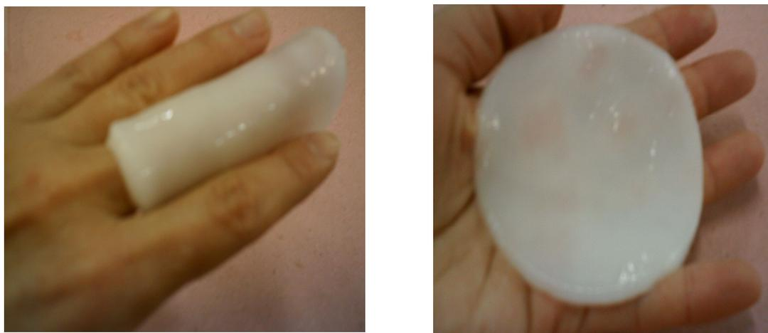
**FIGURA 38** - Membranas de hidrogéis PVAI obtidas por reticulação térmica variando-se a concentração de PEG.
