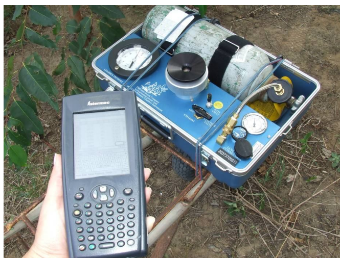
Figura 3 - Bomba de pressão PMS 1003 da PMS Instruments Co, e um coletor de dados, utilizados nas avaliações de potencial hídrico foliar.
