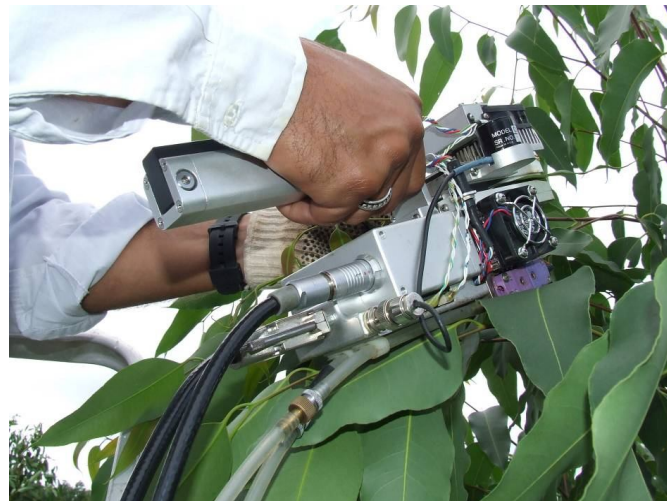
Figura 1 - IRGA modelo Li-6400 da LICOR, utilizado nas avaliações das trocas gasosas.
