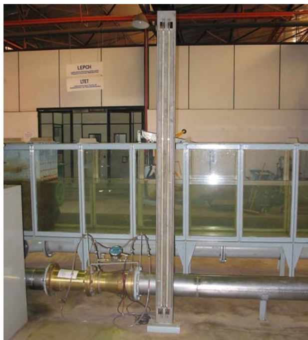
Figura C.6: Medidor Venturi utilizado para medir a vazão.
