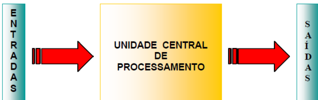
FIGURA 2.6 – Estrutura Básica do CLP
