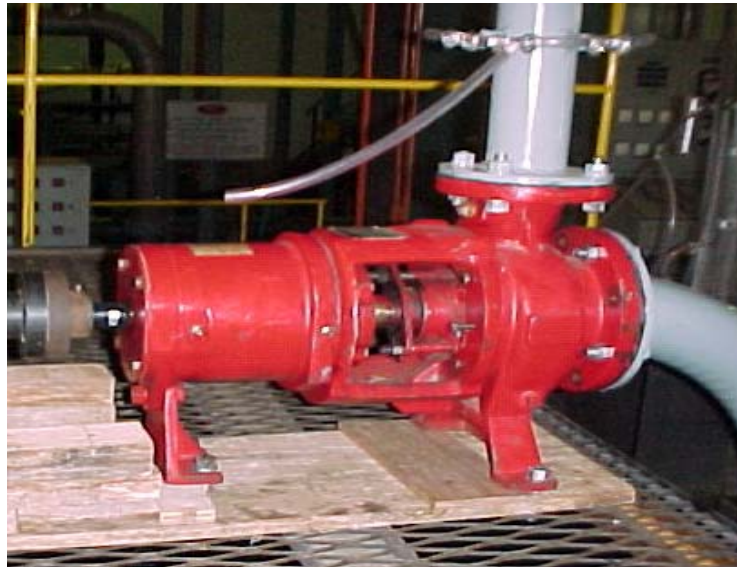
Figura 3.3 - Bomba Funcionando Como Turbina (BFT) Utilizada Nos Ensaio
