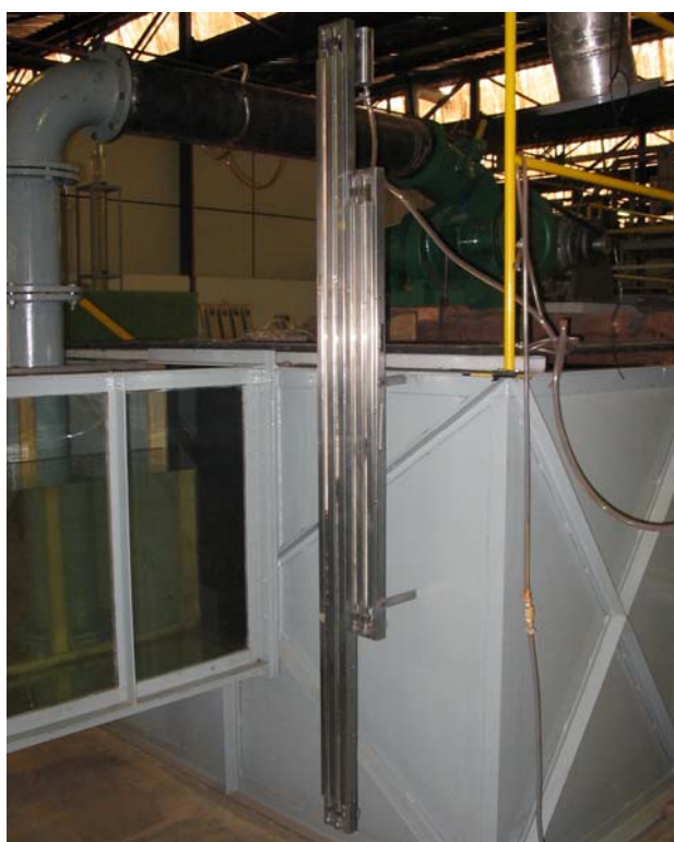
Figura C.2: Manômetro de coluna de mercúrio utilizado para medir a pressão na entrada da turbina.
