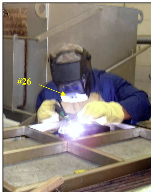
FIGURA 4.50 - Posição do conjunto (cartão + lâmina + filtro) no protetor facial durante o processo de solda TIG de 20 min.
