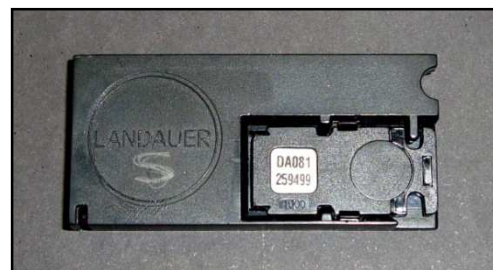
FIGURA 3.4 - Detector \text{Al}_2\text{O}_3:\text{C} InLight Dot fechado e encaixado no adaptador
