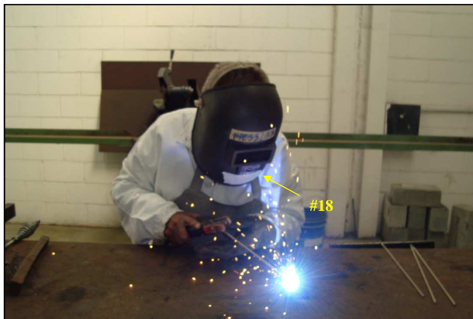
FIGURA 4.42 - Posição do conjunto (cartão + lâmina + filtro) no protetor facial do soldador, durante 2 min de soldagem elétrica.
