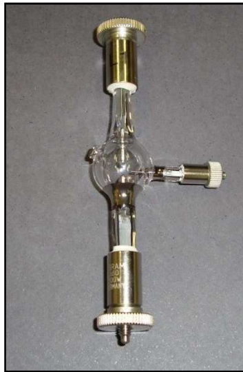
FIGURA 3.5 - Lâmpada de Hg, HBO 200 W da OSRAM acoplada ao Mercury Light Source SP-200, da Bausch & Lomb, do sistema de iluminação UV.
