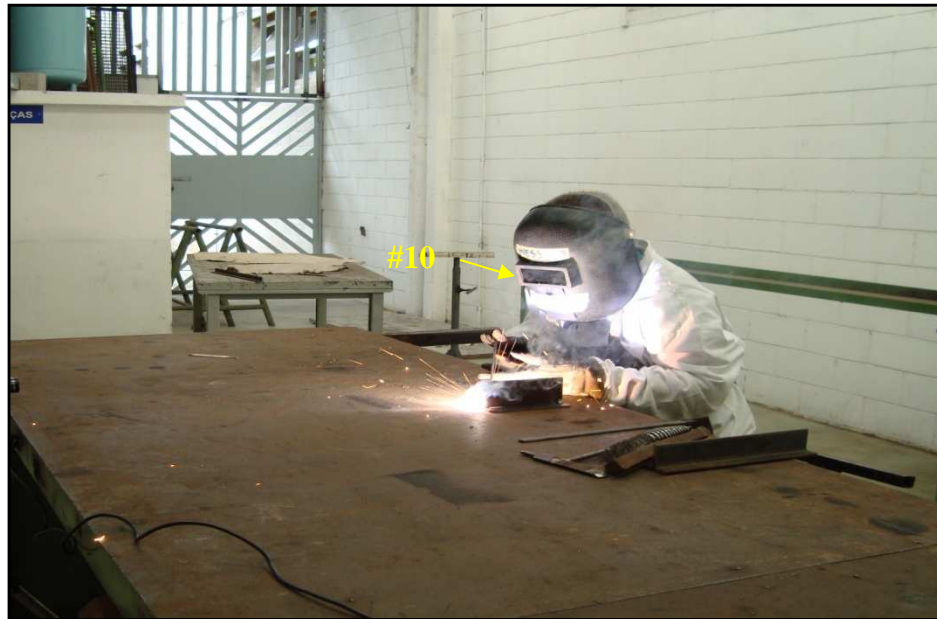
FIGURA 4.36 - Posição do conjunto (cartão+lâmina+filtro) na máscara de proteção do soldador durante 2 min de soldagem elétrica.
