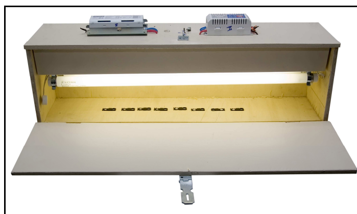
FIGURA 3.11 - Caixa de luz fluorescente para tratamento óptico dos detectores \text{Al}_2\text{O}_3:\text{C} para sua reutilização.
