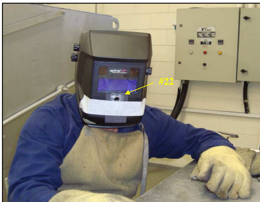
FIGURA 4.46 - Posição do conjunto (cartão + lâmina + filtro) no protetor facial do soldador, durante 5 min de soldagem TIG.
