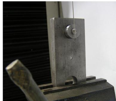
**Figura 2** Fotografia da placa com cilindro giratório
