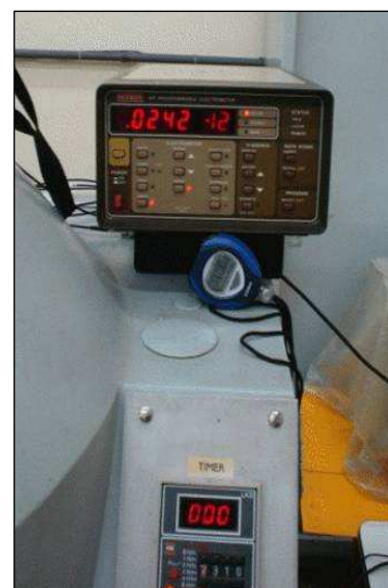
FIG. 33 - Acionamento do eletrômetro e cronômetro.
