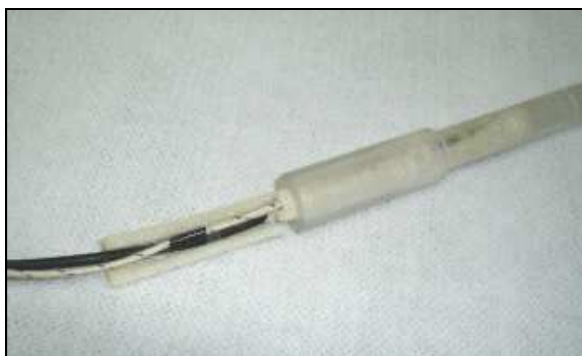
FIG. 16 – Diodo SFH-00206 e Termopar Tipo K cobertos com poliuretano.
