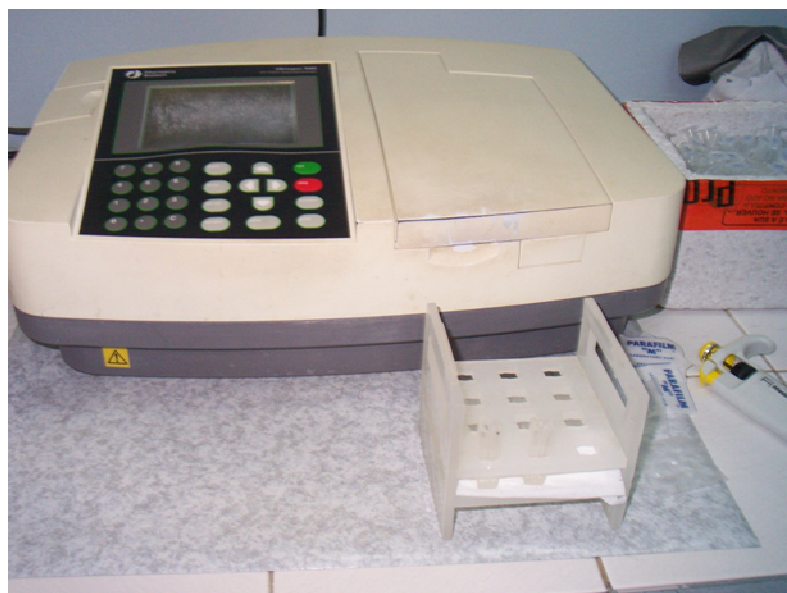
Figura 16 - Espectrofotômetro: equipamento utilizado para medir a atividade da GST.
