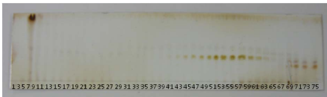
Figura 25. CCD relativa ao primeiro fracionamento da partição em AcOEt de folhas de S. leucanthum utilizando equipamento Quattro HT-Prep MKS e o sistema Hex-AcOEt-MeOH-H 2 O 4:10:4:10, eluição em modo normal revelada com solução de ácido sulfúrico a 20% em MeOH.
