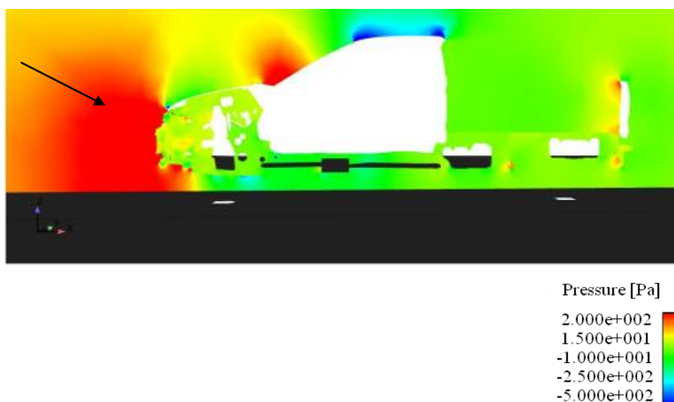
Figura 6.20 – Distribuição de pressões em um plano longitudinal passando pelo centro do veículo
