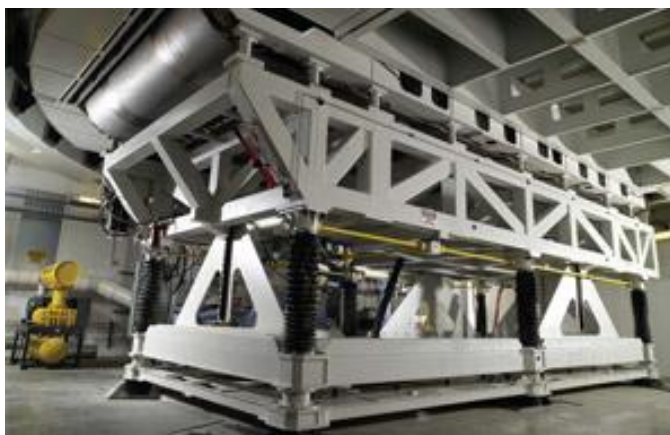
Figura 3.23 – Balança aerodinâmica do túnel de vento Windshear, localizado na Carolina do Norte, EUA.(WINDSHEAR, 2008)
