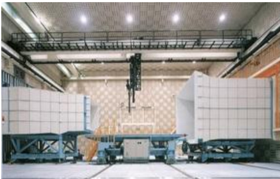
Figura 3.20 - Túnel de vento de seção de testes aberta. (MAIABARA, 2009)
