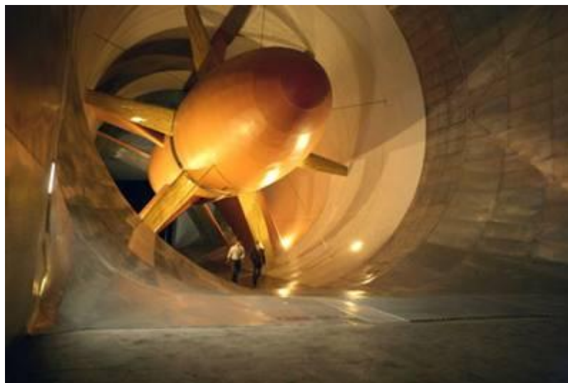
Figura 3.26 – Ventilador do túnel de vento da General Motors, em Warren.(RELATÓRIO DE ENSAIO DA CAMINHONETE, 2007)
