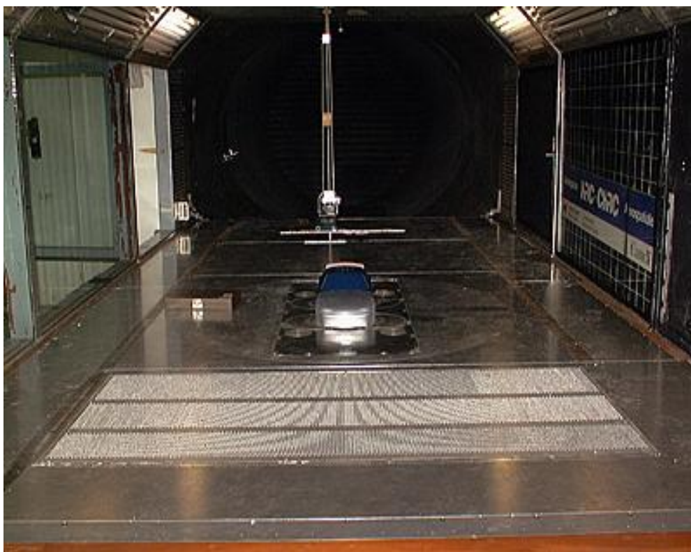
Figura 3.15 – Detalhe do sistema de sucção na entrada da seção de testes do túnel de vento. (DNW, 2009)
