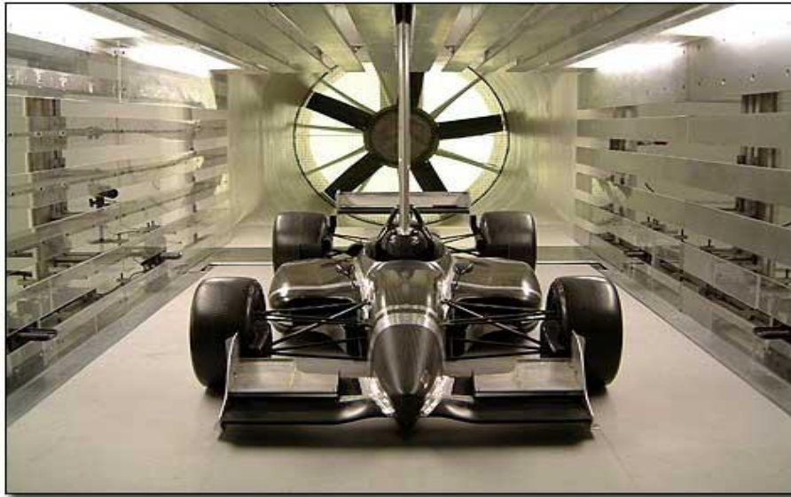
Figura 3.19 – Detalhe da seção de teste de um túnel de vento da Honda F1 (HONDA WIND TUNNEL, 2008)
