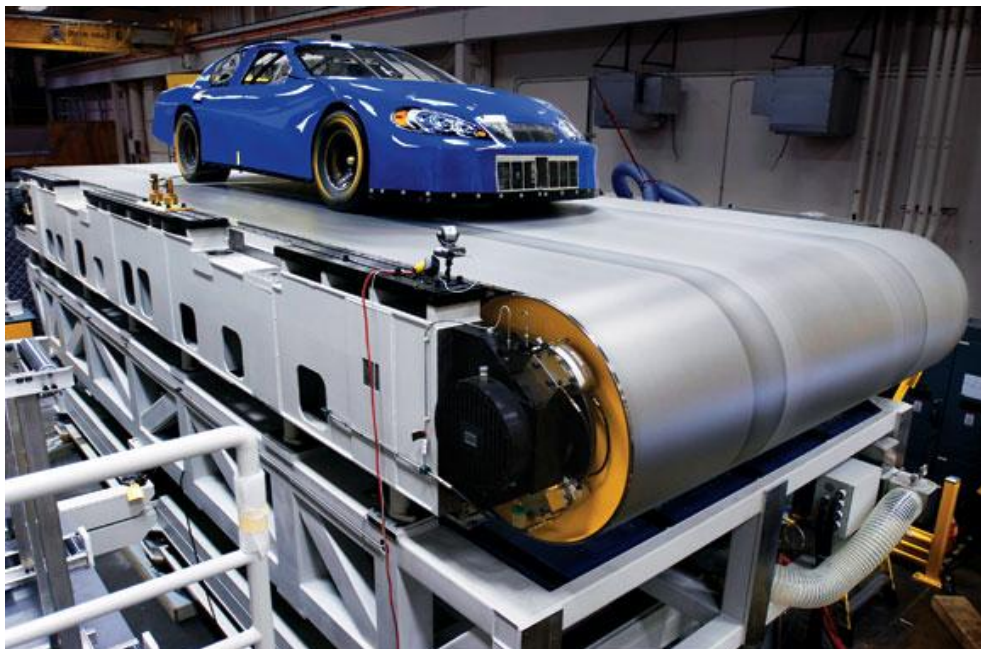
Figura 3.12 – Exemplo de uma esteira rolante, localizada na seção de testes do túnel de vento automotivo Windshear, nos EUA. (WINDSHEAR, 2008)
