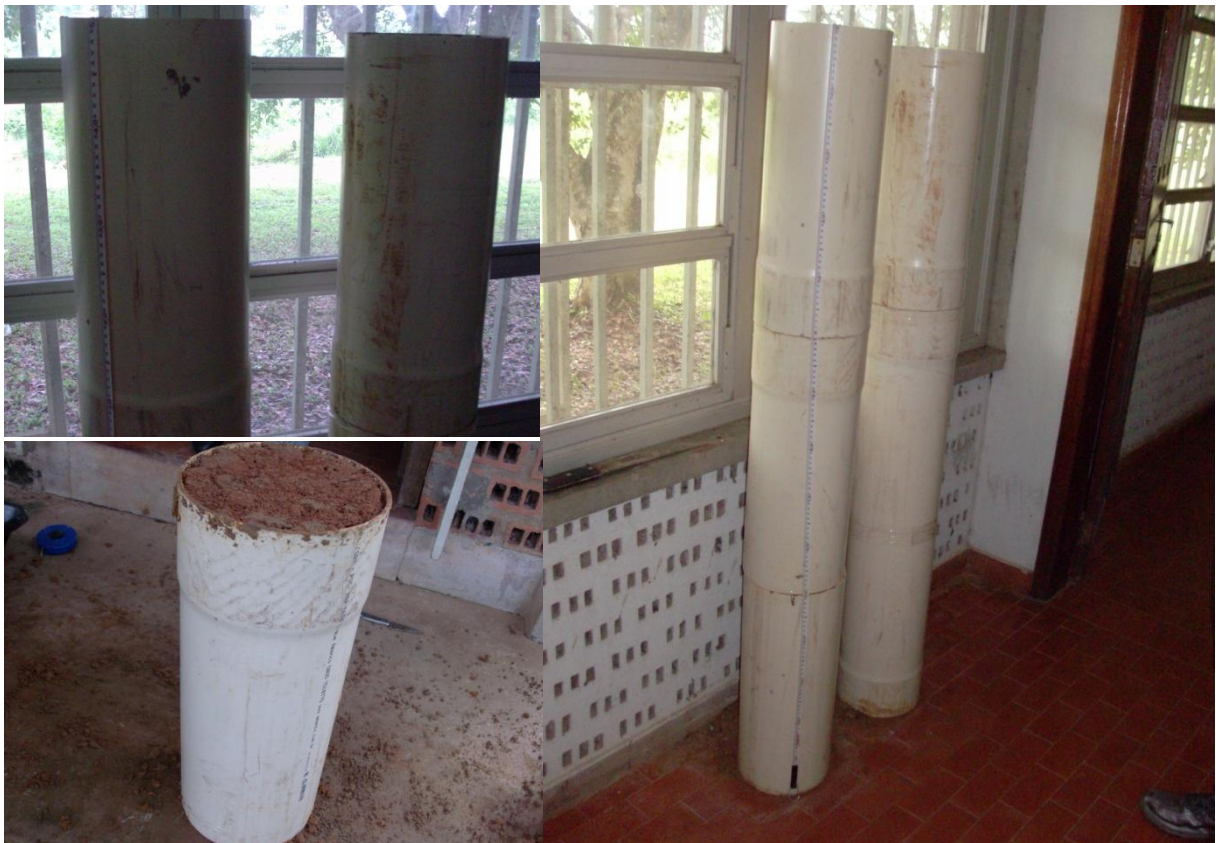
FIGURA 2 - Câmara experimental constituída por tubos de PVC, onde animais da espécie Chibui bari foram introduzidos para avaliação da profundidade de galerias.
