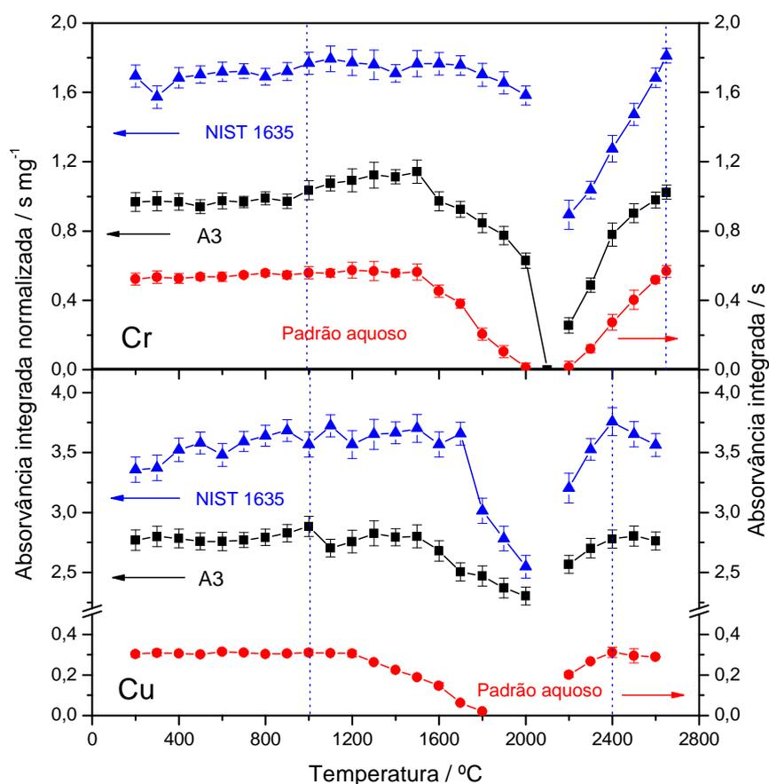
**Figura 25.** Curvas de pirólise e atomização para Cr e Cu em padrão aquoso e amostras de carvão. As linhas pontilhadas em azul representam as temperaturas utilizadas para as determinações.
