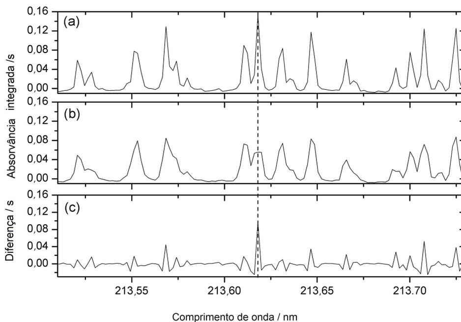
**Figura 24.** Espectro de absorvância integrada medido por HR-CS GF AAS com Z-BC para o P (0,5  $\mu\text{g}$ ) usando Pd+Ca (10+5  $\mu\text{g}$ ) como modificador químico nas vizinhanças de 217,618 nm,  $T_p=400\text{ }^\circ\text{C}$ ,  $T_a=2700\text{ }^\circ\text{C}$ . (a) sem aplicação do campo magnético, (b) sob aplicação do campo e (c) a diferença entre a e b.
