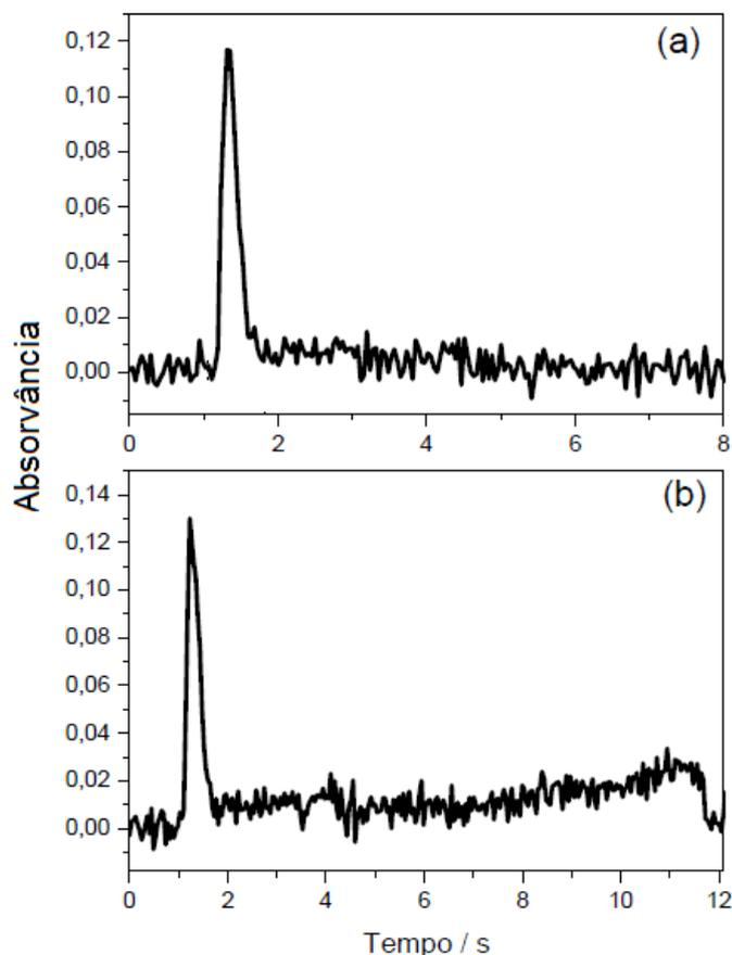
**Figura 10.** Absorvância em função do tempo para 10,0 µg de P obtido por HR-CS GF AAS sem uso de modificador químico,  $T_p=400\text{ °C}$  e  $T_a=2700\text{ °C}$ . (a) Atomização e integração durante 3 s e (b) durante 10 s.
