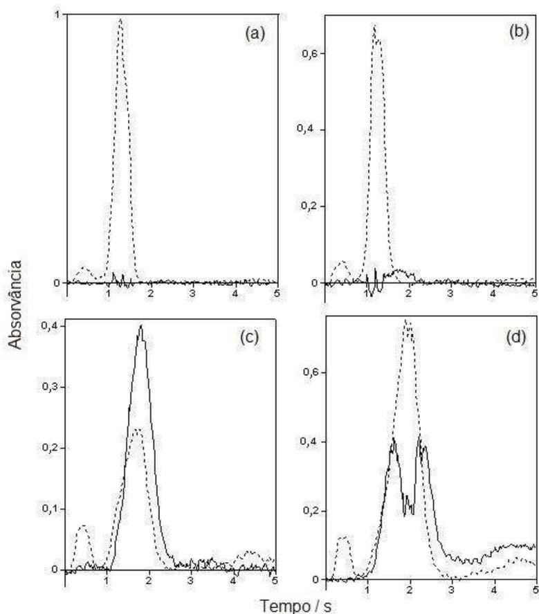
**Figura 19.** Sinais transientes obtidos por GF AAS com Z-BC para o P (linha contínua) e fundo (linha tracejada) em 217,6 nm usando NaF (20 µg) como modificador,  $T_p=400$  °C,  $T_a=2700$  °C. (a) branco; (b) 0,1 µg de P; (c) 3,0 µg de P; (d) 20,0 µg de P.
