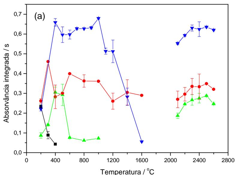
**Figura 6.** Curvas de pirólise ( $T_v=2500\text{ }^\circ\text{C}$ ) e vaporização ( $T_p=400\text{ }^\circ\text{C}$ ) por SS-HR-CS GF MAS para o CS no padrão aquoso de sulfato de amônio ( $1,0\text{ }\mu\text{g}$  de S): (-■-) sem modificador, (-●-) com Ca, com (-▲-) Pd e (-▼-) padrão aquoso de tiouréia ( $2,0\text{ }\mu\text{g}$  de S) com Pd. Todas as curvas foram medidas com uso de W ( $600\text{ }\mu\text{g}$ ) como modificador permanente.
