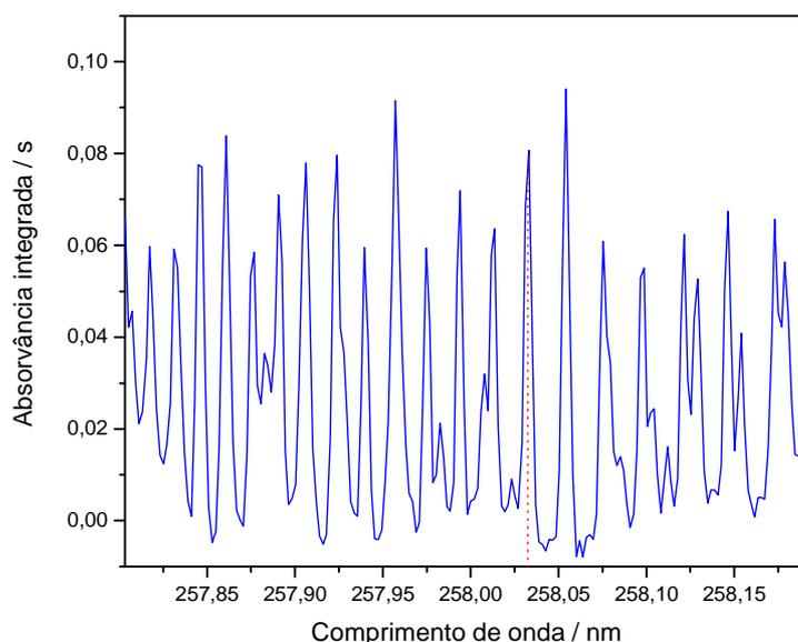
**Figura 4.** Espectro de absorvância integrada para o CS por SS-HR-CS GF MAS em padrão aquoso de  $(\text{NH}_4)_2\text{SO}_4$  ( $5,0 \mu\text{g}$  de S),  $T_p=200 \text{ }^\circ\text{C}$  e  $T_v=2500 \text{ }^\circ\text{C}$ . A linha em vermelho representa o comprimento de onda avaliado em  $258,033 \text{ nm}$  usado para a determinação de S.
