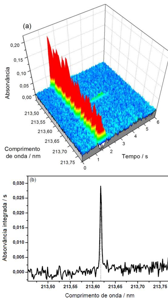
**Figura 14.** Absorvância em função do comprimento de onda e tempo (a) e espectro de absorvância integrada após LSBC (b) obtido para 1,0  $\mu\text{g}$  de P por HR-CS GF AAS com 20  $\mu\text{g}$  de NaF como modificador químico,  $T_p=1100$   $^{\circ}\text{C}$  e  $T_a=2700$   $^{\circ}\text{C}$ . As linhas pontilhadas em (b) representam a posição do dublete não-ressonante do P em 213,547 nm e 213,618 nm.
