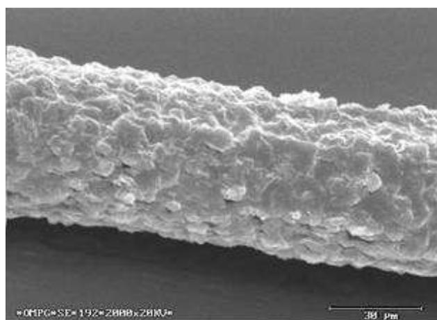
**Figura 2.** Imagem de microscopia eletrônica de varredura de uma fibra de celulose preparada pelo processo de Lyocell com carvão ativado (100%) incorporado.<sup>83</sup>
