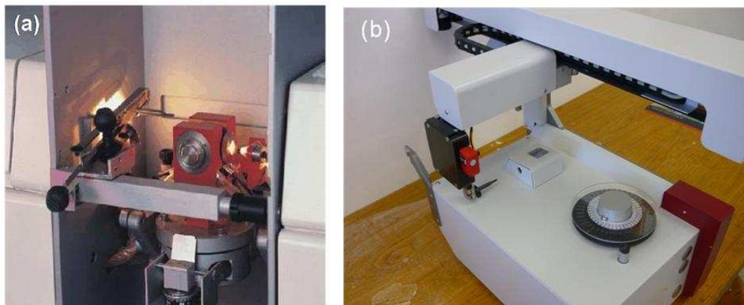
**Figura 3.** Acessórios para introdução de sólidos no atomizador eletrotérmico (a) manual e (b) automático (Analytik Jena).
