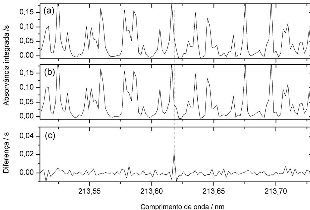
**Figura 23.** Espectro de absorvância integrada medido por HR-CS GF AAS com Z-BC para o P (0,5  $\mu\text{g}$ ) sem uso de modificador químico nas vizinhanças de 217,618 nm,  $T_p=400$  °C,  $T_a=2700$  °C. (a) sem aplicação do campo magnético, (b) sob aplicação do campo e (c) a diferença entre a e b.
