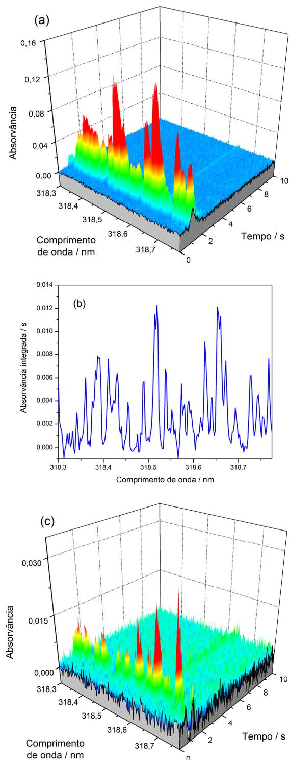
**Figura 35.** Correção por mínimos quadrados para o V por SS-HR-CS GF AAS na amostra A1 em  $318,540 \pm 0,24$  nm. (a) espectro tridimensional para amostra obtido somente com correção para eventos contínuos, (b) espectro para molécula diatômica contendo S obtido a partir do padrão aquoso de  $(\text{NH}_4)_2\text{SO}_4$  e (c) espectro para amostra após a correção por mínimos quadrados.
