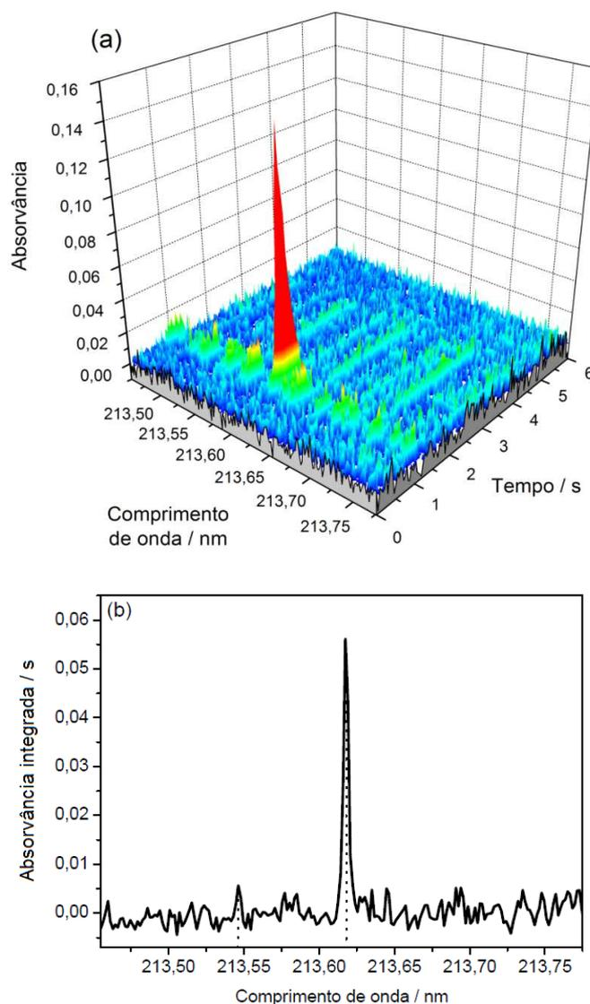
**Figura 12.** Espectro obtido para 1,0  $\mu\text{g}$  de P por HR-CS GF AAS com 10  $\mu\text{g}$  de La como modificador químico,  $T_p=400\text{ }^\circ\text{C}$  e  $T_a=2700\text{ }^\circ\text{C}$ . ( a) Absorvância em função do comprimento de onda e tempo e (b) espectro de absorvância integrada após LSBC para PO. As linhas pontilhadas em (b) representam a posição do dublete não-ressonante do P em 213,547 nm e 213,618 nm.
