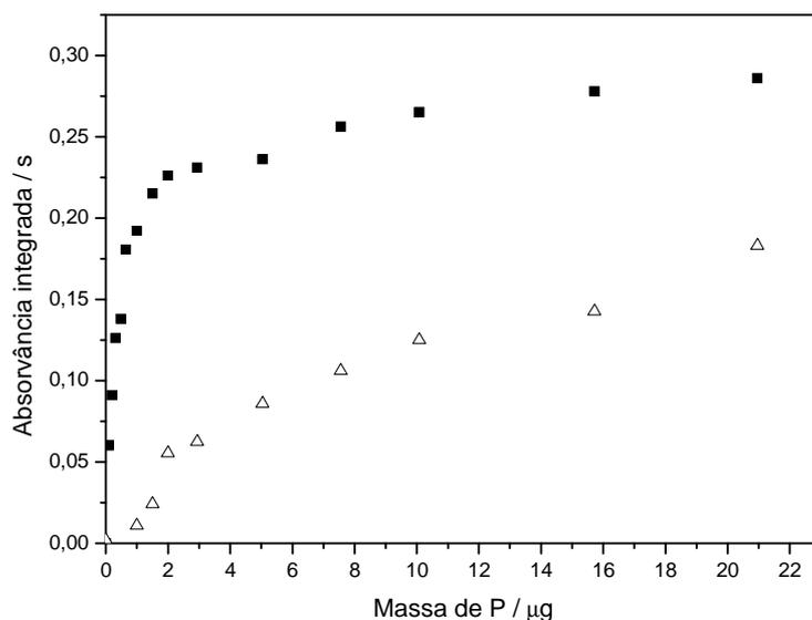
**Figura 20.** Curva de calibração para o P medida em 213,6 nm por GF AAS com Z-BC usando Pd (10 µg) como modificador; (■) sinal de absorção atômica corrigido do fundo e (△) sinal do fundo,  $T_p=400\text{ }^\circ\text{C}$ ;  $T_a=2700\text{ }^\circ\text{C}$ .
