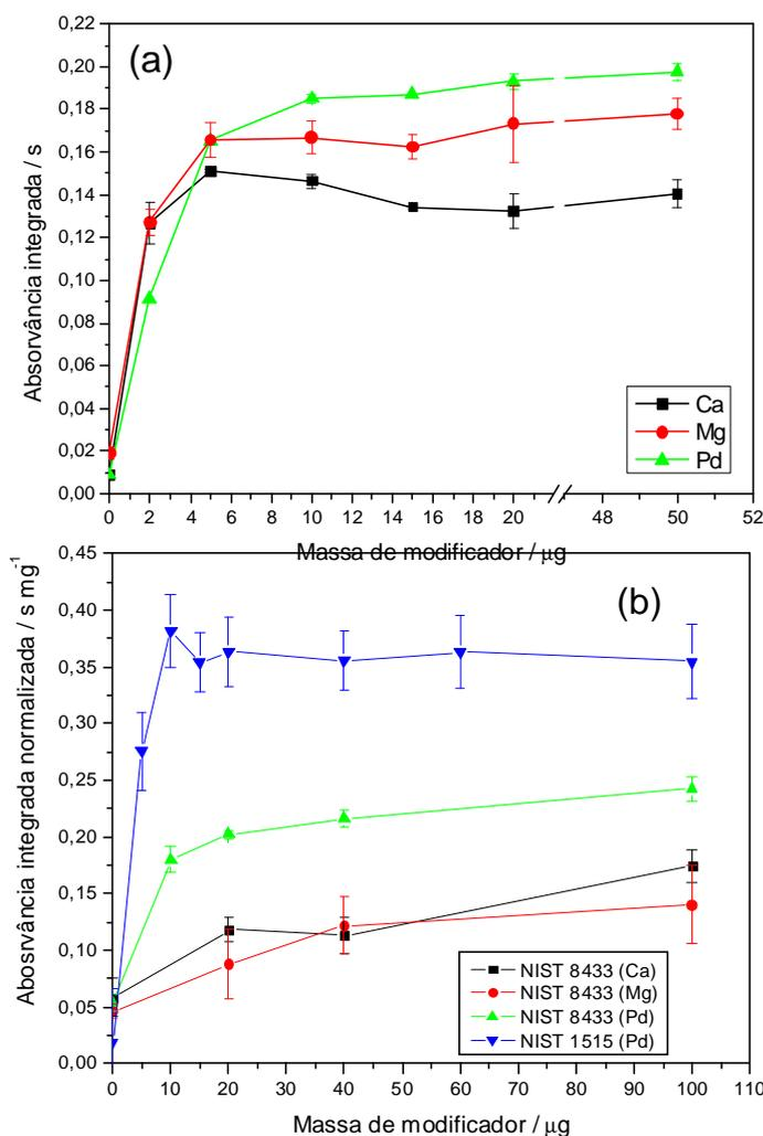
**Figura 5.** Estudo da massa de modificador para o CS no padrão aquoso de S (2,0 µg) e nas amostras de farelo de milho e de folha de maçã NIST 8433 e NIST 1515, respectivamente, utilizando W (600 µg) como modificador químico permanente,  $T_p=600$  °C e  $T_v=2500$  °C.
