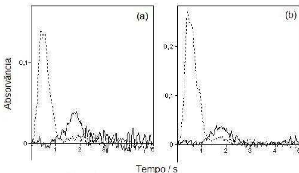
**Figura 17.** Sinais transientes obtidos por GF AAS com Z-BC para absorção atômica do P (linha contínua) e fundo (linha tracejada) em 217,6 nm sem uso de modificador químico.  $T_p=400$  °C,  $T_a=2700$  °C. (a) 5,0 µg de P; (b) 1,0 µg de P.
