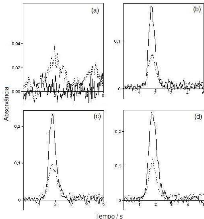
**Figura 22.** Sinais transientes obtidos por GF AAS com Z-BC para o P (linha contínua) e fundo (linha tracejada) em 217,6 nm usando Pd+Ca (10+5 µg) como modificador,  $T_p=400$  °C,  $T_a=2700$  °C. (a) branco; (b) 0,25 µg de P; (c) 0,5 µg de P; (d) 1,0 µg de P.
