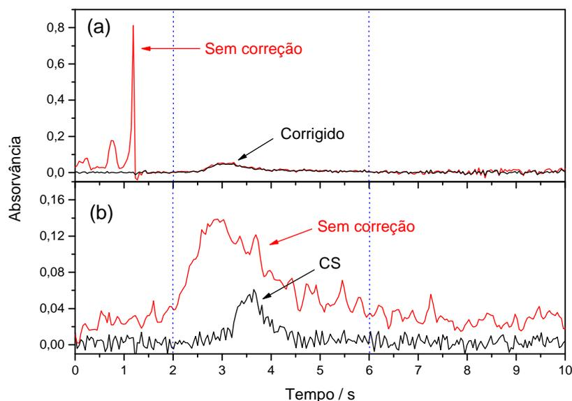
**Figura 8.** Absorvância em função do tempo para o CS na amostra NIST 8433 usando Pd (40  $\mu\text{g}$ ) como modificador, (a)  $T_p=200\text{ }^\circ\text{C}$  e (b)  $T_p=1000\text{ }^\circ\text{C}$ , e  $T_v=2500\text{ }^\circ\text{C}$  para (a) e (b). As linhas pontilhadas em azul representam os limites de integração do sinal transiente.
