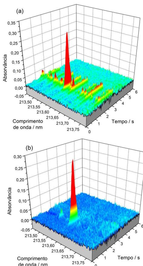
**Figura 15.** Absorvância em função do comprimento de onda e tempo obtido para 3,0  $\mu\text{g}$  de P por HR-CS GF AAS com (10+5)  $\mu\text{g}$  de Pd+Ca como modificador químico,  $T_p=1700\text{ }^\circ\text{C}$  e  $T_a=2700\text{ }^\circ\text{C}$ .
