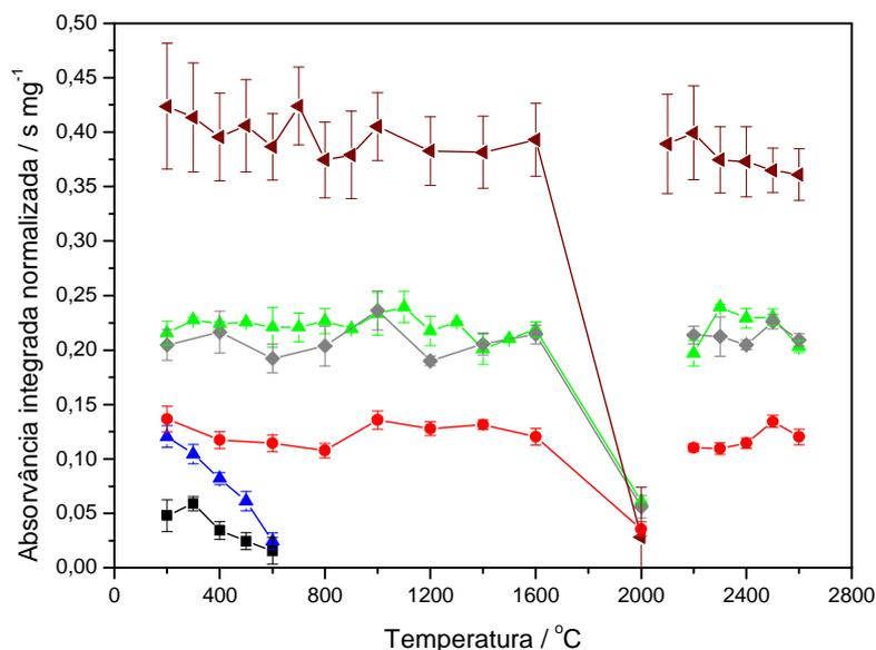
**Figura 7.** Curvas de pirólise ( $T_v=2500\text{ }^\circ\text{C}$ ) e vaporização ( $T_p=900\text{ }^\circ\text{C}$ ) por SS-HR-CS GF MAS para o CS nas amostras NIST 8433: (-■-) sem modificador, (-●-) com Ca e (-▲-) com Pd; NIST 1568a: (-▲-) sem modificador e (-◆-) com Pd; e NIST 1515 (-▼-) com Pd. Todas as curvas foram medidas com uso de W ( $600\text{ }\mu\text{g}$ ) como modificador permanente.
