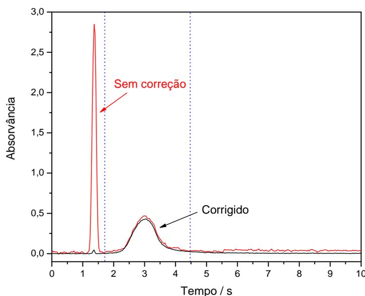
**Figura 29.** Absorvância em função do tempo para o Cr em 357,868 nm na amostra NIST 1635,  $T_p=200$  °C e  $T_a=2650$  °C. As linhas pontilhadas representam os limites de integração do sinal transiente.
