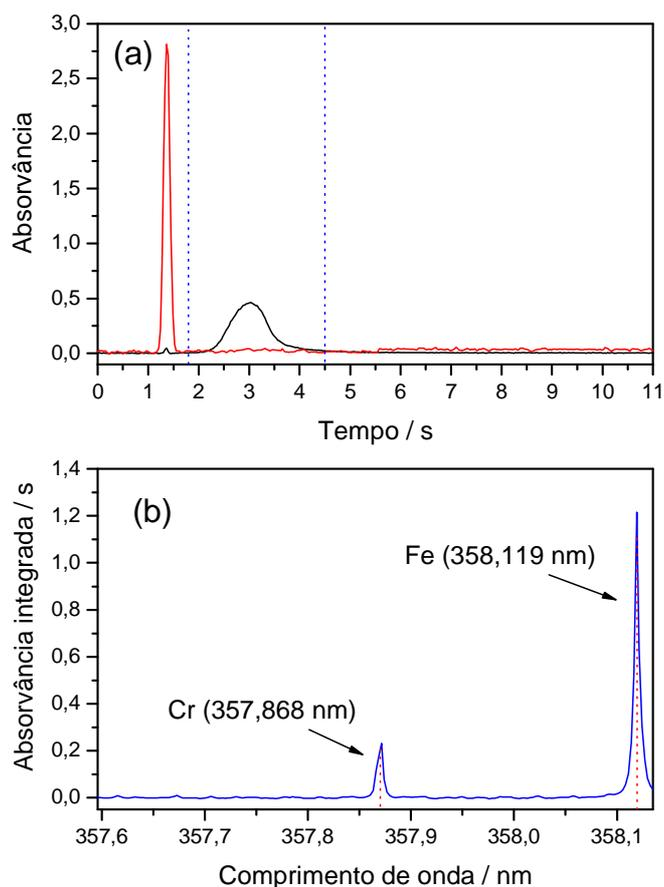
**Figura 33.** Absorvância em função do tempo (a) para o Cr em 357,869 nm e espectro de absorvância integrada (b) para o Cr em 357,869  $\pm$  0,5 nm por SS-HR-CS GF AAS na amostra NIST 1635 integrando sinal transiente até 4,5 s. As linhas pontilhadas em (a) representam os limites de integração do sinal transiente.
