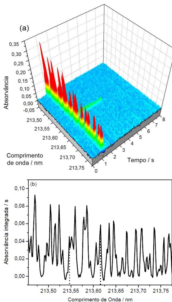
**Figura 9.** Absorvância em função do comprimento de onda e tempo (a) e espectro de absorvância integrada (b) para 10,0  $\mu\text{g}$  de P obtido por HR-CS GF AAS sem uso de modificador químico,  $T_p=400\text{ }^\circ\text{C}$  e  $T_a=2700\text{ }^\circ\text{C}$ . As linhas pontilhadas em (b) representam a posição do dublete não-ressonante do P em 213,547 nm e 213,618 nm.
