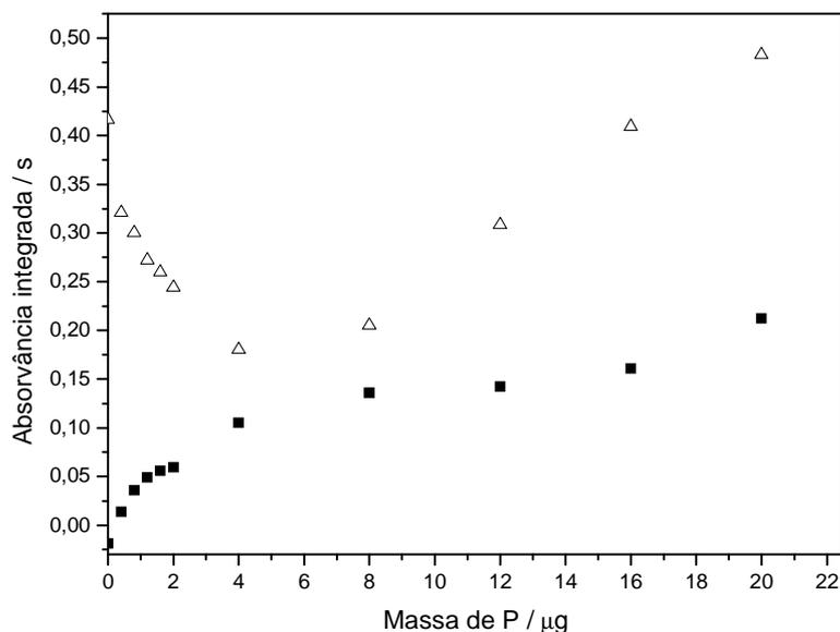
**Figura 18.** Curva de calibração para o P medida em 213,6 nm por GF AAS com Z-BC usando 20  $\mu\text{g}$  de NaF como modificador; (■) sinal de absorção atômica corrigido do fundo e (△) sinal do fundo;  $T_p=400\text{ }^\circ\text{C}$ ;  $T_a=2700\text{ }^\circ\text{C}$ .
