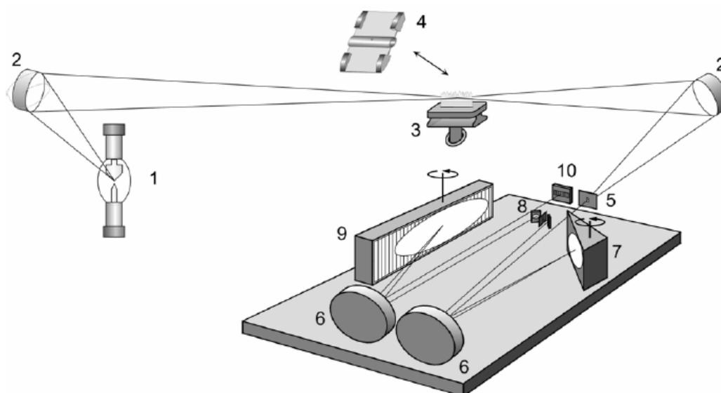
**Figura 1.** Representação esquemática do HR-CS AAS. (1) lâmpada de arco curto de xenônio, (2) espelhos elipsoidais, (3 ou 4) atomizador (chama ou forno de grafite), (5) fenda de entrada do monocromador, (6) espelhos parabólicos, (7) prisma *Littrow*, (8) espelhos de deflexão e fenda intermediária variável, (9) rede *echelle*, (10) detector CCD.<sup>4</sup>
