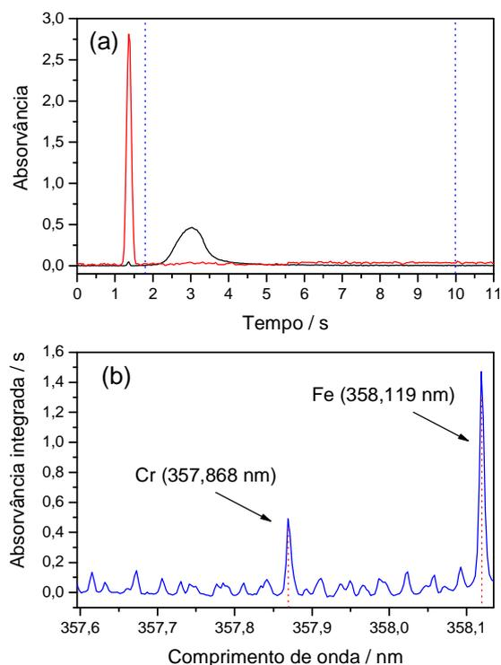
**Figura 32.** Absorvância em função do tempo (a) para o Cr em 357,869 nm e espectro de absorvância integrada (b) para o Cr em  $357,869 \pm 0,5$  nm por SS-HR-CS GF AAS na amostra NIST 1635 integrando sinal transiente por 10 s. As linhas pontilhadas em (a) representam os limites de integração do sinal transiente.
