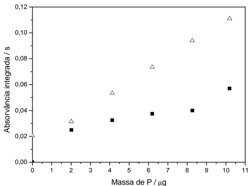
**Figura 16.** Curva de calibração para o P medida em 213,6 nm por GF AAS com Z-BC sem uso de modificador; (—■—) sinal de absorção atômica corrigido do fundo e (—Δ—) sinal do fundo;  $T_p=400\text{ }^\circ\text{C}$ ;  $T_a=2700\text{ }^\circ\text{C}$ .
