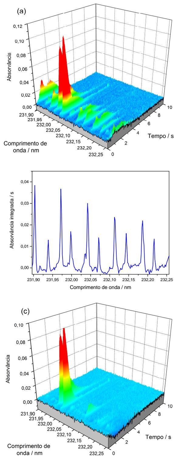
**Figura 34.** Correção por mínimos quadrados na região das linhas de Ni em 232,003 nm e 232,138 nm. (a) espectro tridimensional para amostra obtido somente com correção para eventos contínuos, (b) espectro para o SiO obtido a partir do padrão aquoso de Si e (c) espectro para amostra A6 após a correção por mínimos quadrados.
