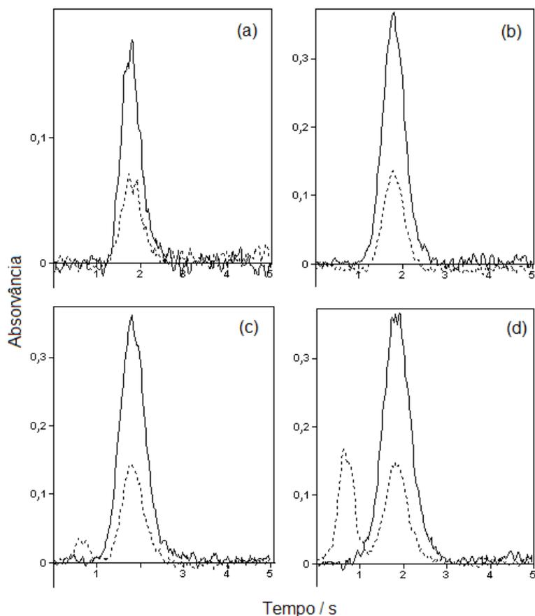
**Figura 21.** Sinais transientes obtidos por GF AAS com Z-BC para o P (linha contínua) e fundo (linha tracejada) em 217,6 nm usando Pd (10 µg) como modificador,  $T_p=400$  °C,  $T_a=2700$  °C. (a) 0,2 µg de P; (b) 2,0 µg de P; (c) 7,0 µg de P; (d) 20,0 µg de P.
