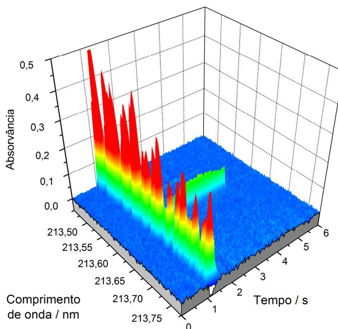
**Figura 11.** Absorvância em função do comprimento de onda e tempo para 6,0  $\mu\text{g}$  de P obtido por HR-CS GF AAS com plataforma de Ta e sem uso de modificador químico,  $T_p=400\text{ }^\circ\text{C}$  e  $T_a=2700\text{ }^\circ\text{C}$ .
