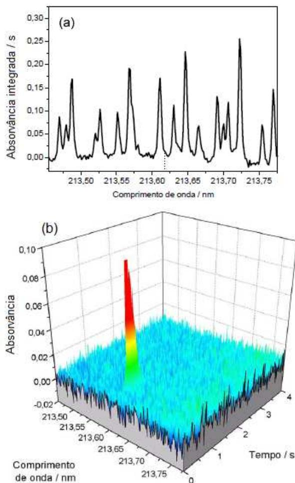
**Figura 13.** Espectro por HR-CS GF AAS com  $T_p=400\text{ }^\circ\text{C}$  e  $T_a=2700\text{ }^\circ\text{C}$ . (a) Absorvância em função do comprimento de onda para 5  $\mu\text{L}$  de  $\text{HNO}_3$  5% v/v e (b) absorvância em função do comprimento de onda e tempo após LSBC para PO+NO. A linha pontilhada em (a) representa a posição da linha principal do P em 213,618 nm.
