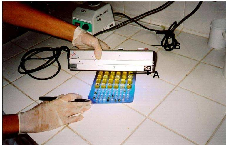
**Figura 4.3. Leitura de Coliformes Fecais com lâmpada ultravioleta utilizando Cartela Quanti-Tray®/2000 do conjunto de reagentes Colilert®-18. A – Cartela Quanti-Tray®/2000 B – Lâmpada ultravioleta.**
