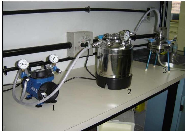
**Figura 4.4. Sistema de filtração Millipore®: 1, Bomba de vácuo com manômetros; 2, Recipiente de pressão; 3, Suporte de membranas.**
