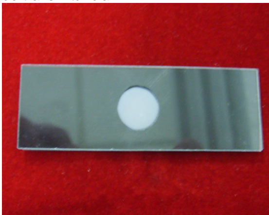
Figura 6 - Matriz preenchida por compósito e coberta por lâmina de vidro.
