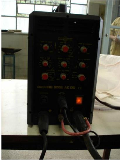
Figura 4 -Máquina de solda TIG Castotig 2000 CA-CC, com gás argônio: visão posterior.
