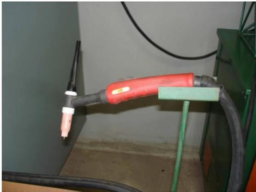
Figura 6 -Máquina de solda TIG Castotig 2000 CA-CC, com gás argônio: maçarico.
