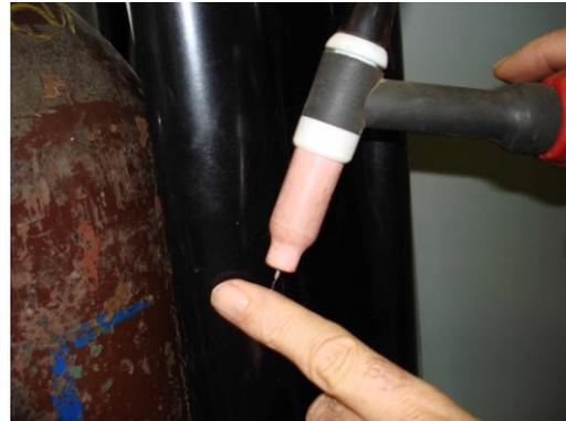
Figura 7 -Máquina de solda TIG Castotig 2000 CA-CC, com gás argônio: visualização do arco elétrico.
