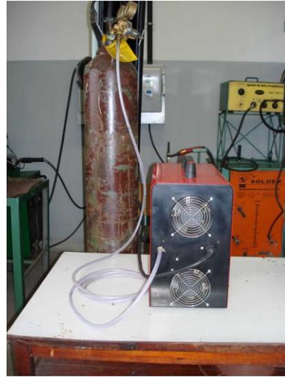
Figura 5 -Máquina de solda TIG Castotig 2000 CA-CC, com gás argônio: balão de gás hélio.
