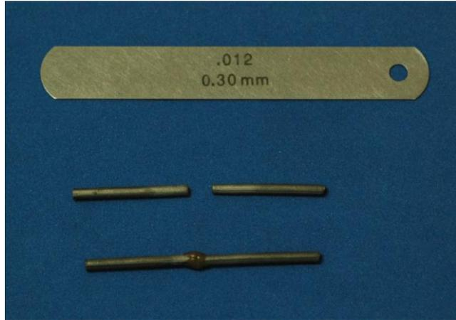
Figura 3 - Corpo de prova antes e após a fixação e espaçador utilizado.
