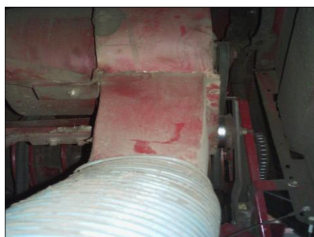
Figura 16 - Tubo condutor de eliminação de impurezas.
