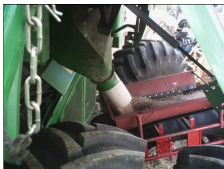
Figura 18 - Descarga dos grãos em esteira transportadora.
