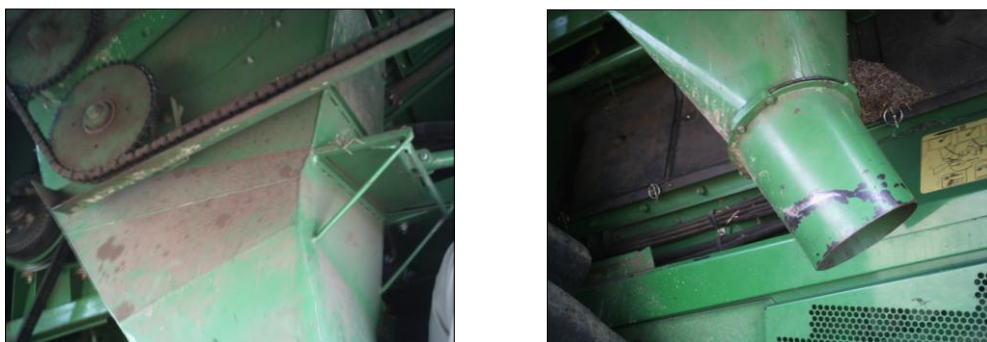
Figura 17 - Tubo de descarga de grãos inferior da máquina.
