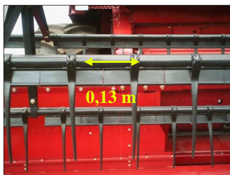
Figura 12 - Espaçamento dos dedos recolhedores originais das plataformas de grãos.
