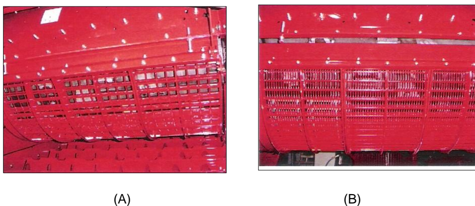
Figura 8 - Modelos de côncavo: (A) de barras redondas, (B) de arame fino.
