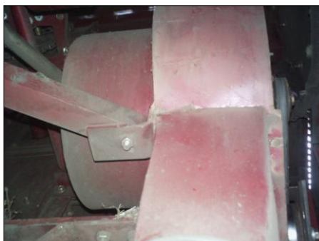
Figura 14 - Exaustor de pó adaptado na saída do elevador de grãos limpos.
