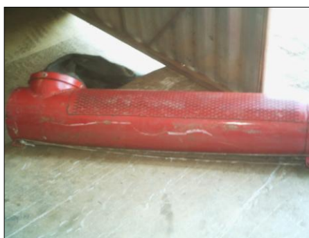
Figura 21 - Tubo de descarga adaptado com chapa perfurada para eliminação da poeira.
