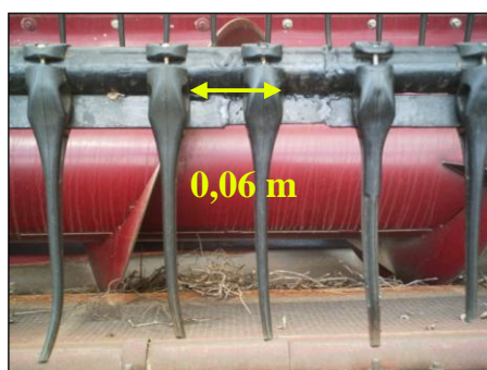
Figura 13 - Espaçamento dos dedos recolhedores modificados nas plataformas de grãos.
