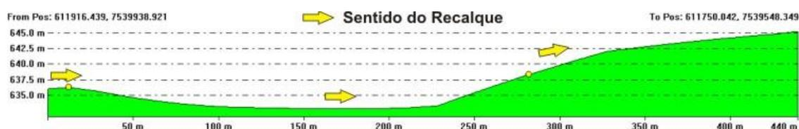
**Figura 46:** Perfil topográfico do emissário por recalque 1.1.
