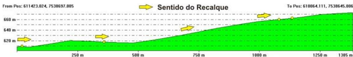
**Figura 48:** Perfil topográfico do emissário por recalque 1.2.
