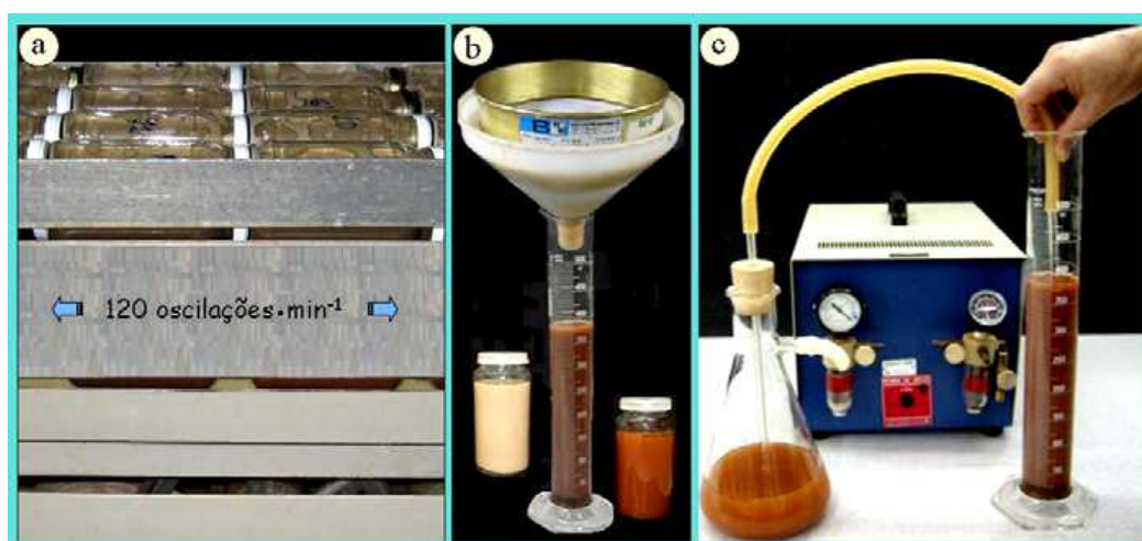
Figura 5. Detalhe do procedimento do método de Bouyoucos: a) agitação/dispersão; b) separação da fração areia e coleta da fração argila e silte na proveta; c) sucção da argila. (adaptado de Almeida, 2008).
