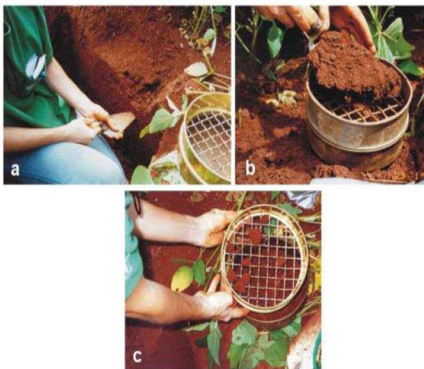
Figura 6. Detalhes das etapas do procedimento de amostragem no campo (pré-tratamento): a) trincheira; b) bloco de solo; c) tamanho dos agregados (adaptado de Madari, 2004).
