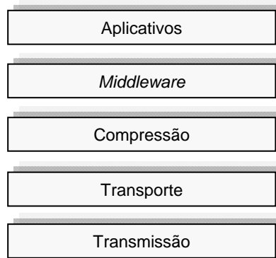
Figura 6 - Arquitetura em camadas da TV Digital.
