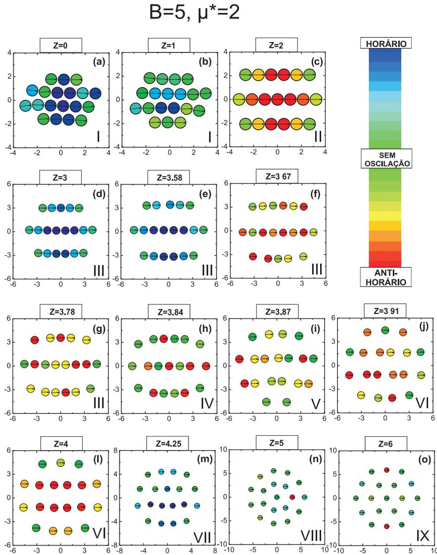
Figura 16: Nas figuras (a)-(o) apresentam-se os modos normais de vibração do sistema de  $N=19$  partícula sem campo magnético  $B=5$ , para vários valores de carga  $Z$ . As cores representam o sentido da componente de rotação dos modos normais de cada partícula. Cada configuração tem um intervalo simétrico de ângulo ao qual as cores indicadoras do sentido de rotação estão associadas.
