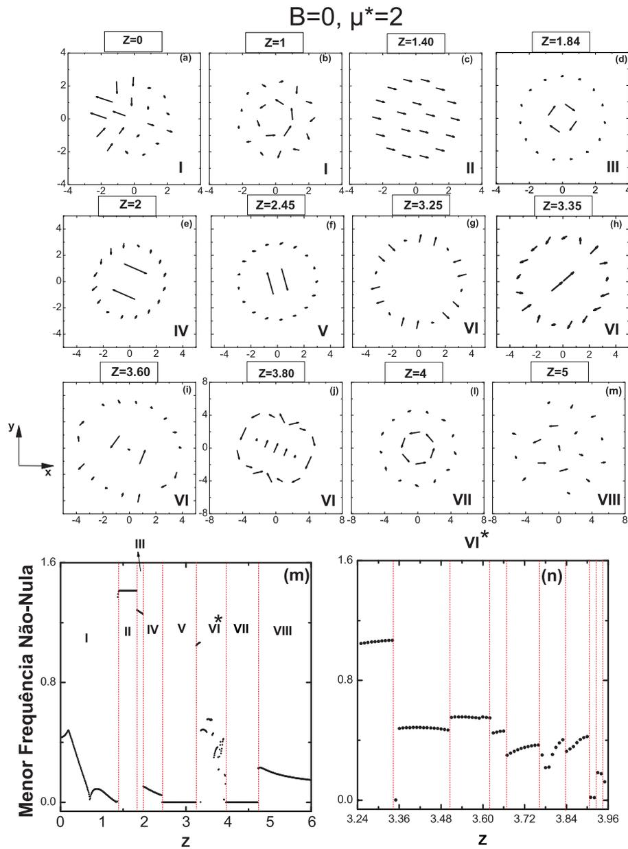
Figura 11: Nas figuras (a)-(l) apresentam-se os modos normais de vibração do sistema de  $N=19$  partículas em campo magnético  $B=0$ , para vários valores de carga  $Z$ . Os gráficos (m) e (n) apresentam a menor frequência não-nula (m), e uma ampliação da região VI da figura (m).
