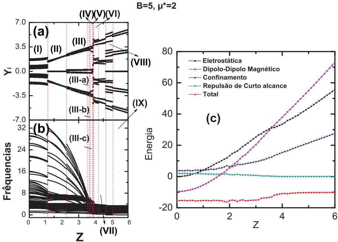
Figura 14: Nas figuras (a) e (b) apresentam-se, respectivamente, as coordenadas  $Y$  de cada partícula (a), e o espectro de frequências dos modos normais do sistema de  $N=19$  partículas para campo magnético  $B=5$ , para vários valores de carga  $Z$ . Em (c), apresenta-se a contribuição para a energia por partícula de cada termo de interação e do potencial de confinamento do sistema.
