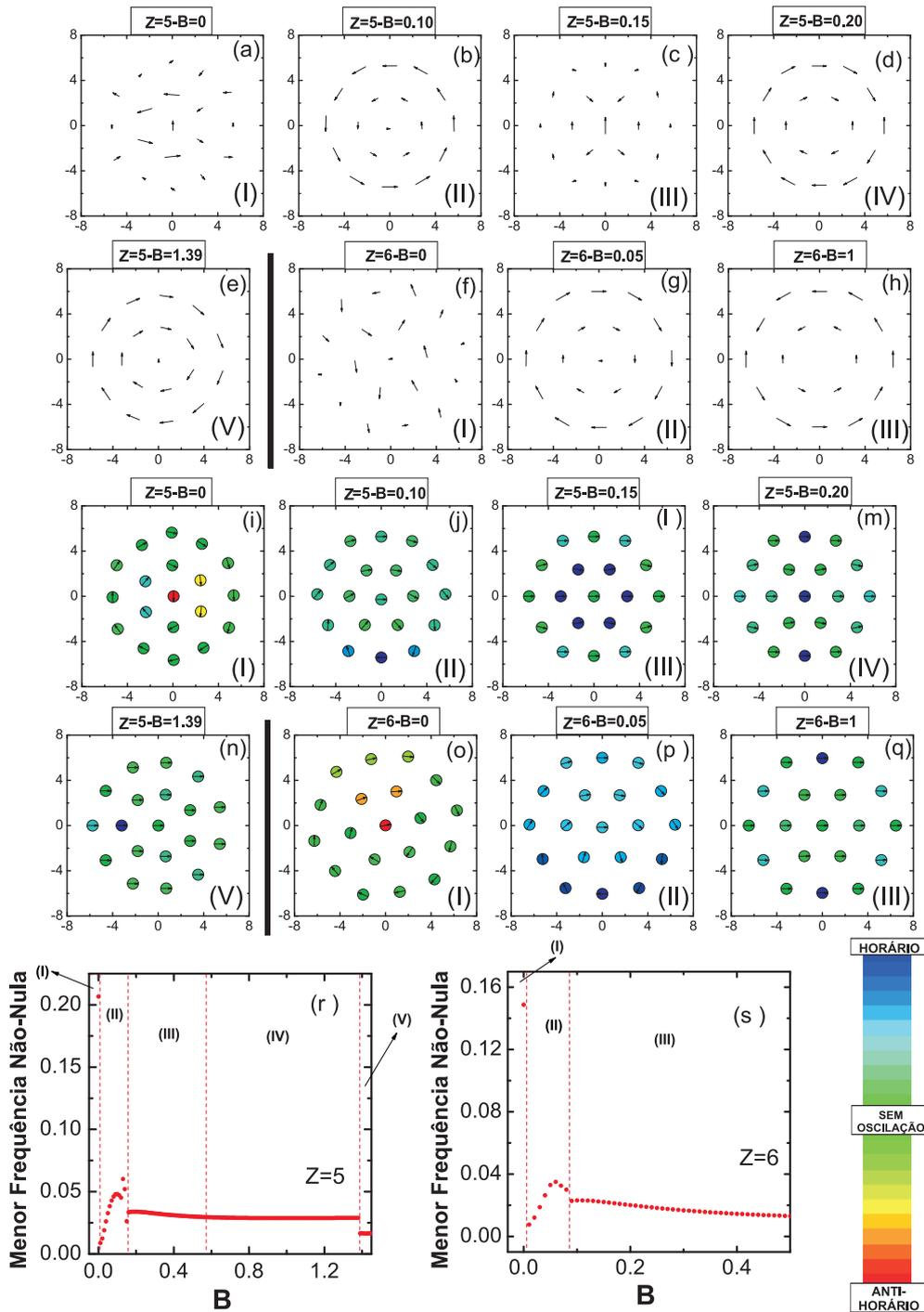
Figura 21: Nas figuras (a)-(h) apresentam-se os modos normais de vibração de um sistema de  $N=19$  partículas para os casos de carga  $Z=5$  [(a)-(e)], e  $Z=6$  [(f)-(h)]. As figuras de (i) a (q) apresentam os modos de rotação do mesmo sistema para os casos de carga  $Z=5$  (i)-(n), e  $Z=6$  (o)-(q). Em (r) e (s) é mostrada a mínima frequência não-nula em função do campo magnético aplicado ao sistema.
