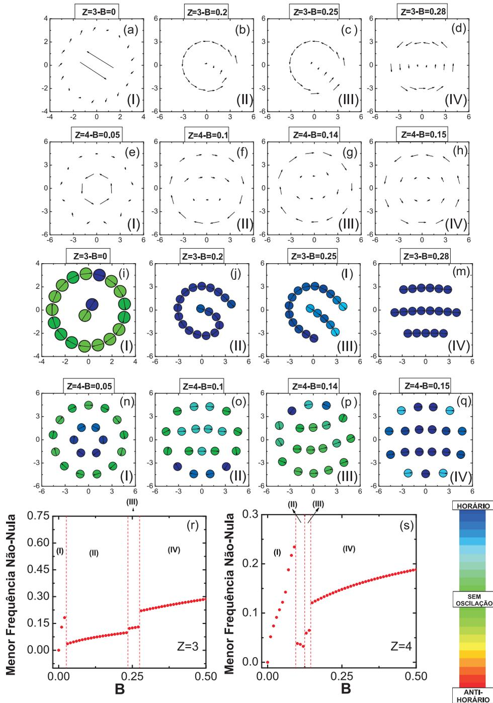
Figura 20: Nas figuras (a)-(h) apresentam-se os modos normais de vibração de um sistema de  $N=19$  partículas para os casos de carga  $Z=3$  [(a)-(d)], e  $Z=4$  [(e)-(h)]. As figuras (i)-(q) apresentam os modos de rotação do mesmo sistema para os casos de carga  $Z=3$  [(i)-(m)], e  $Z=4$  [(n)-(q)]. Em (r) e (s) é mostrada a menor frequência não-nula em função do campo magnético aplicado ao sistema.
