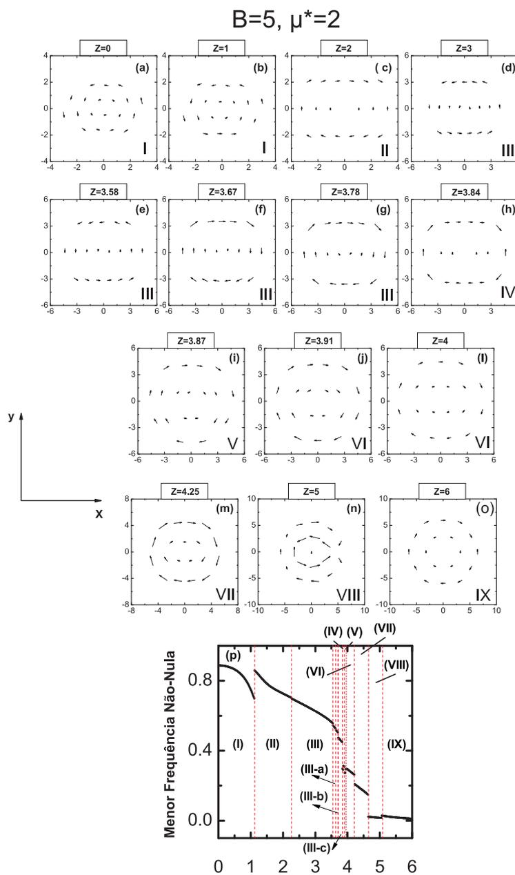
Figura 15: Nas figuras (a)-(o) apresentam-se os modos normais de vibração do sistema de  $N=19$  partículas em campo magnético  $B=5$ , para vários valores de carga  $Z$ . O gráfico (p) apresenta a menor frequência não-nula em função de  $Z$ .
