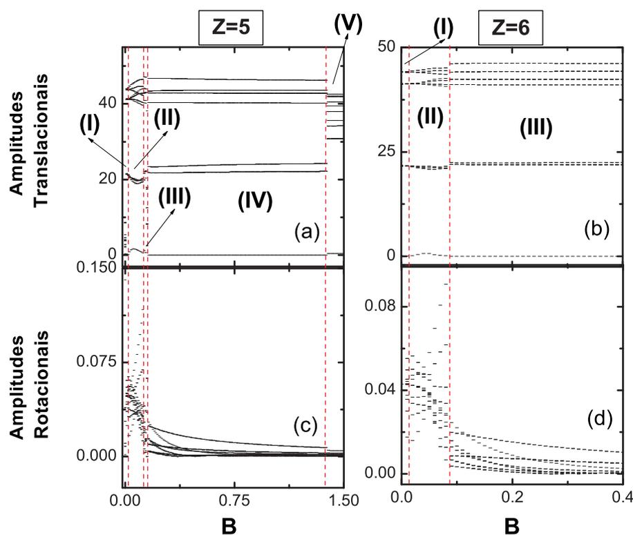
Figura 23: Nas figuras (a)-(d) as amplitudes de translação [(a),(b)] e rotação [(c),(d)] associadas à vibração de um sistema de  $N=19$  partículas para os casos  $Z=5$  [(a),(c)], e  $Z=6$  [(b),(d)], analisando-se agora a dependência do sistema com o campo magnético  $B$ .
