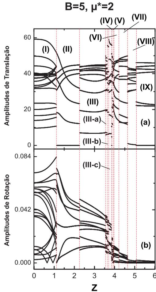
Figura 17: Nas figuras (a) e (b) apresentam-se as amplitudes das componentes de translação (a) e rotação (b) associadas à vibração de um sistema de  $N=19$  partículas em campo magnético  $B=5$ , para vários valores de carga  $Z$ .
