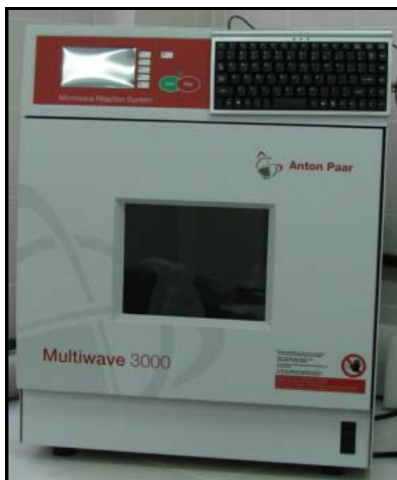
Figura 3.1: Fotografia do forno microondas utilizado para digestão em sistema fechado.
