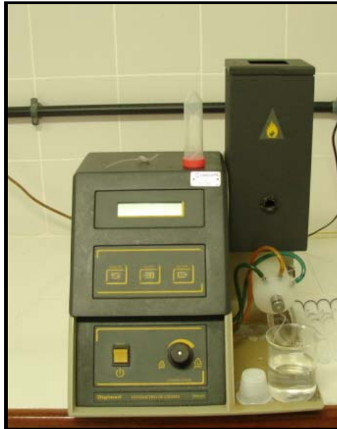
Figura A.1.1: Fotografia do Fotômetro de Chama utilizado para a determinações iônicas. Fonte: TAVARES (2009).
