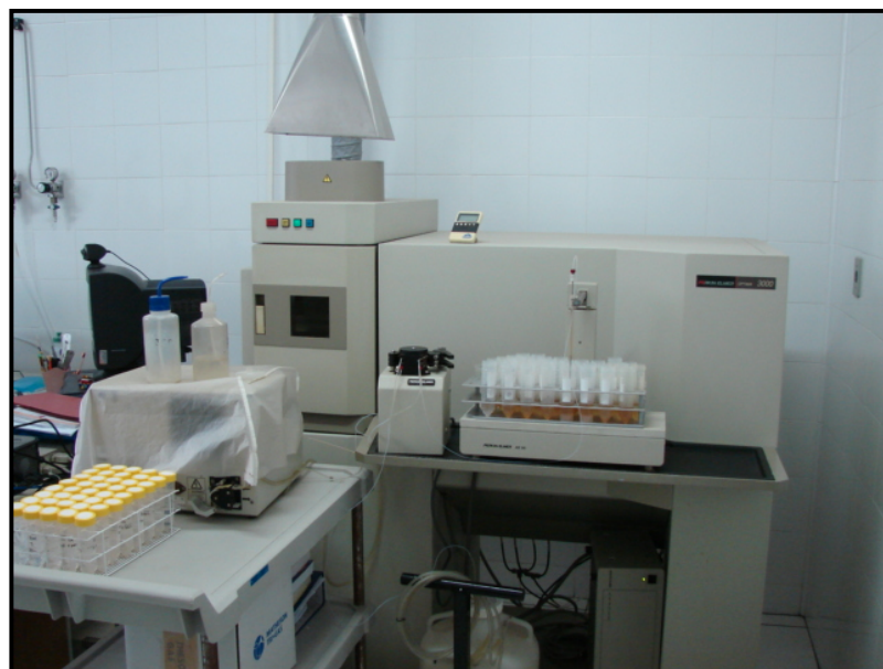
Figura 3.2: Fotografia do ICP-Plasma utilizado nas várias determinações iônicas.
