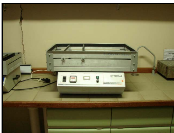
Figura 3.8: Fotografia da mesa agitadora da Embrapa Solos utilizado nos ensaios de batelada. Fonte: TAVARES (2009)
