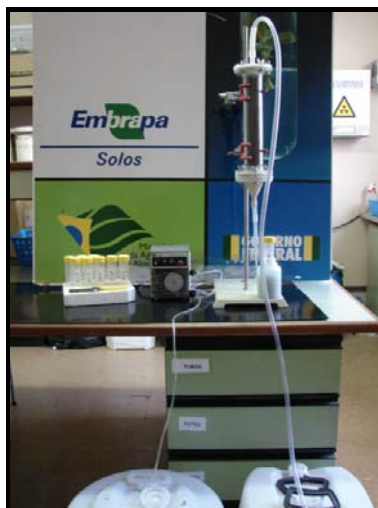
Figura 3.9: Fotografia do sistema de coluna de leito fixo da Embrapa Solos.
