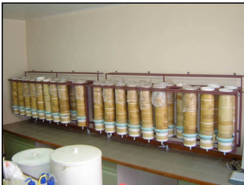
Figura 3.3: Detalhe da montagem das colunas de solo para estudos de agentes quelantes para fins de aumento da disponibilidade de metais pesados na solução e matriz do solo. Fonte: TAVARES (2009).
