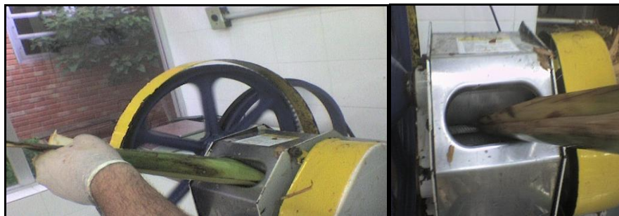
Figura 4 Moenda de caldo de cana com rolos de aço inoxidável (Inox), utilizada para a moagem das bainhas foliares de palmeira real australiana (Acervo do autor).
