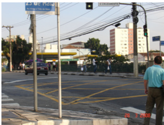
Imagem10 - Cruzamento sobre a Av. 23 de Maio com a R. Tutóia, bairro do Paraíso, São Paulo, onde se observa luminárias da Av. encostadas no viaduto, quase na altura da cabeça das pessoas, ofuscando o pedestre à noite Fonte: Isac Roizenblatt, 28/03/2008.
